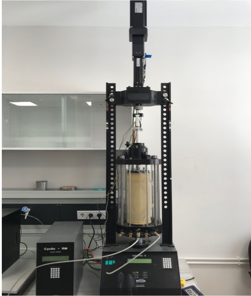
Şekil 3.19 : Esneklik Modülü deneyinin laboratuvarda uygulanması.
