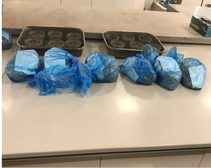
Şekil 3.15: Sıkıştırma işlemi için hazırlanan tabakalar.
