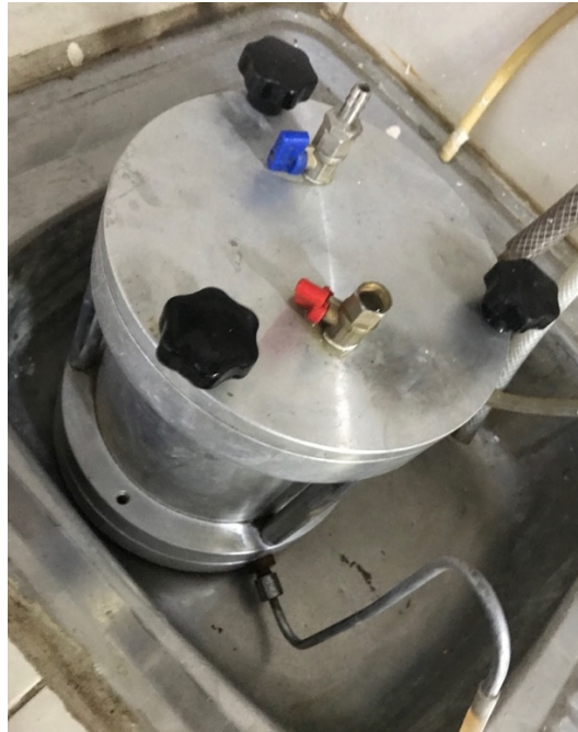
Şekil 3.10 : Sabit Seviyeli Permeabilite deneyinde kullanılan kalıp.
