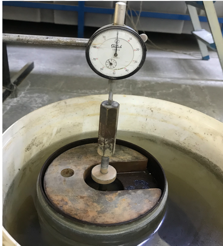
Şekil 3.9 : 24 Saat suda bekletilen CBR numunesi.
