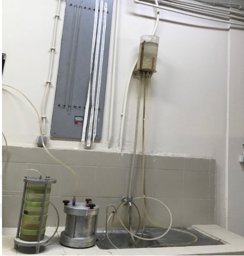
Şekil 3.11 : Hazırlanan numuneye yapılan vakum uygulaması.
