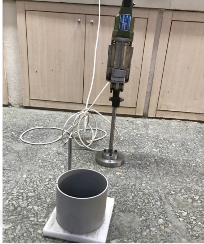
Şekil 3.23 : Kullanılan titreşimli sıkıştırma aleti.
