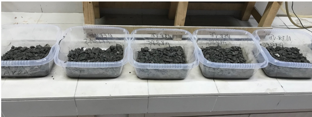
Şekil 3.21 : Optimum su içeriğinin eklenip karıştırıldığı temel tabakaları.
