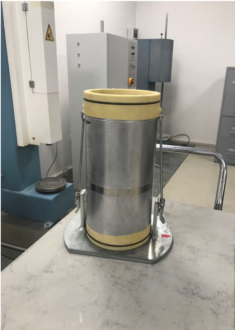
Şekil 3.14 : Sıkıştırma işlemi için hazırlanan kalıp.
