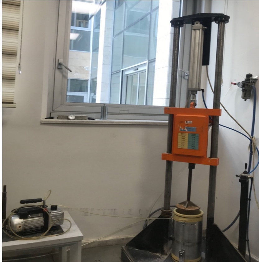
Şekil 3.16 : Esneklik Modülü deneyinde numunesinin sıkıştırılması.
