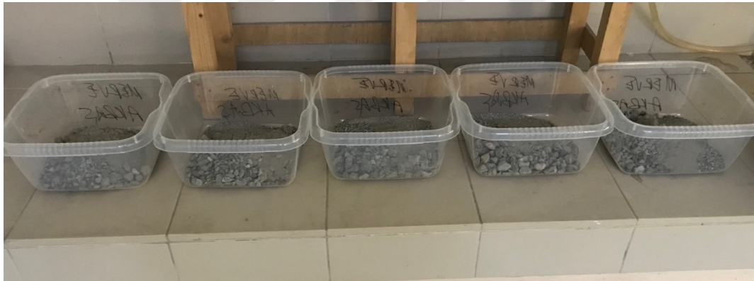
Şekil 3.20 : Sıkıştırılacak her temel tabakasının ayrı ayrı hazırlanması.
