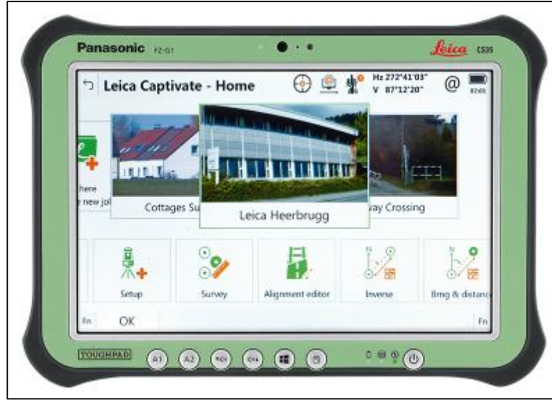
Şekil 3.1: Dahili ekranı olan el kontrol ünitesi.
