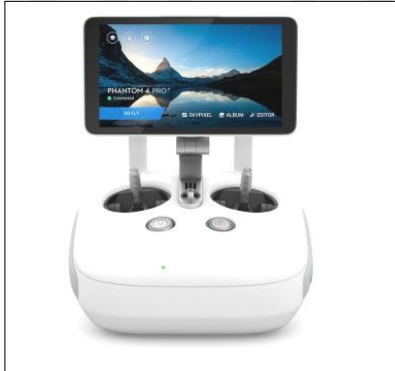
Şekil 3.2: Harici ekranı olan el kontrol ünitesi.
