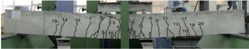
Şekil 4.81. KI-ND-1-4 Numunesinde Oluşan Çatlaklar
