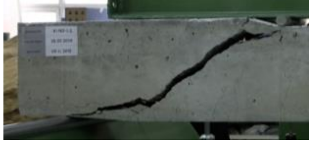
Şekil 4.95. KI-ND-1-2 Numunesinin Kırılma Tipi
