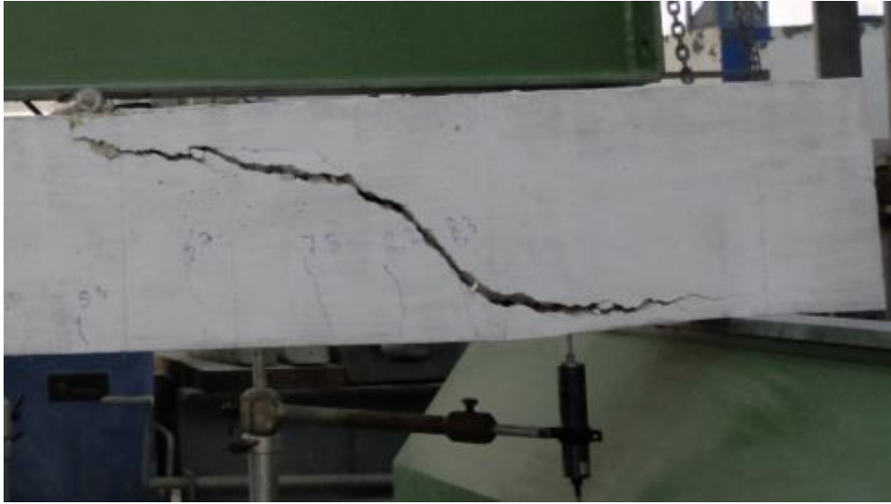
Şekil 4.17. KI-DD-3-3 Numunesinin Kırılma Tipi
