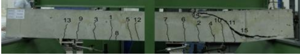
Şekil 4.43. KI-ND-2-3 Numunesinde Oluşan Çatlaklar
