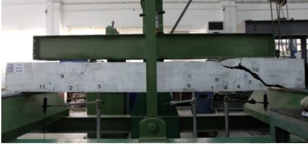
Şekil 4.23. KI-DD-3-2 Numunesinde Oluşan Çatlaklar
