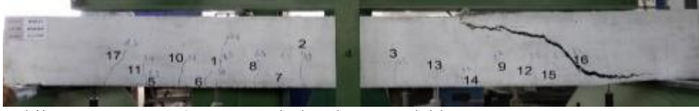
Şekil 4.18. KI-DD-3-3 Numunesinde Oluşan Çatlaklar
