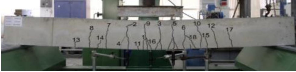
Şekil 4.37. KI-DD-2-4 Numunesinde Oluşan Çatlaklar
