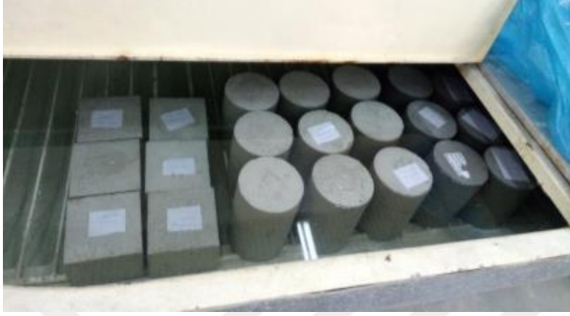
Şekil 3.9. Deney Numunelerinin Kür Havuzunda Muhafaza Edilmesi
