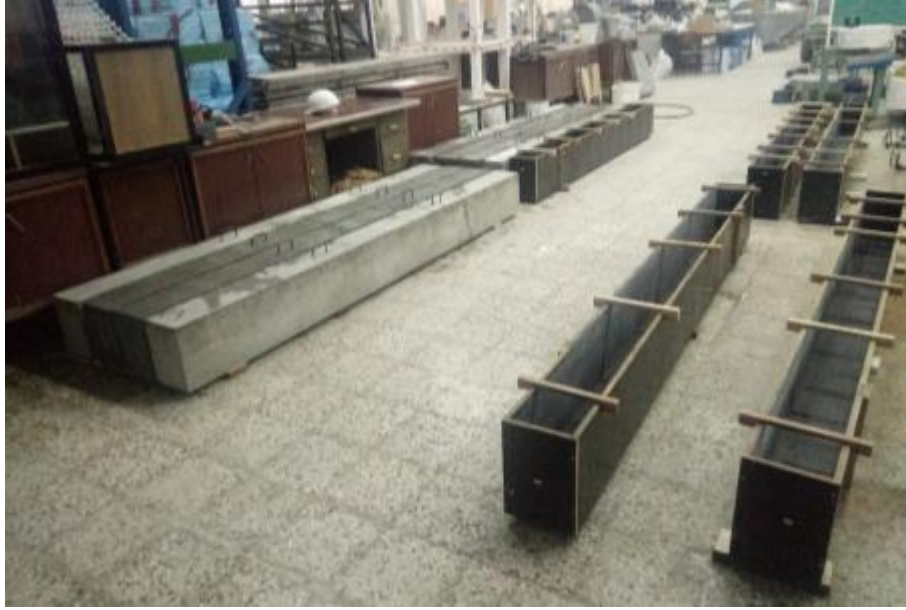
Şekil 3.7. Deney Kirişlerinin Hazırlanması ve Bakımı
