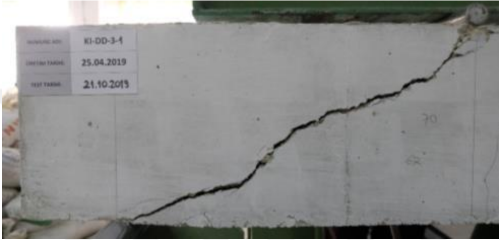
Şekil 4.32. KI-DD-3-1 Numunesinin Kırılma Tipi
