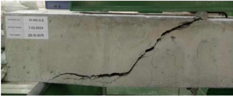
Şekil 4.49. KI-DD-2-2 Numunesinin Kırılma Tipi
