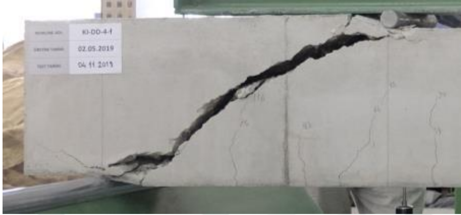
Şekil 4.78. KI-DD-4-1 Numunesinin Kırılma Tipi
