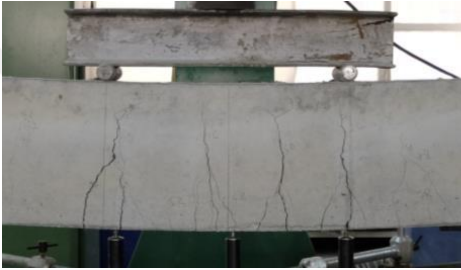
Şekil 4.38. KI-ND-2-4 Numunesi Eğilme Bölgesinde Oluşan Çatlaklar
