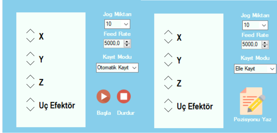
Şekil 3.67. Elle kayıt modu ve otomatik kayıt modu için yerleştirilen butonlar
