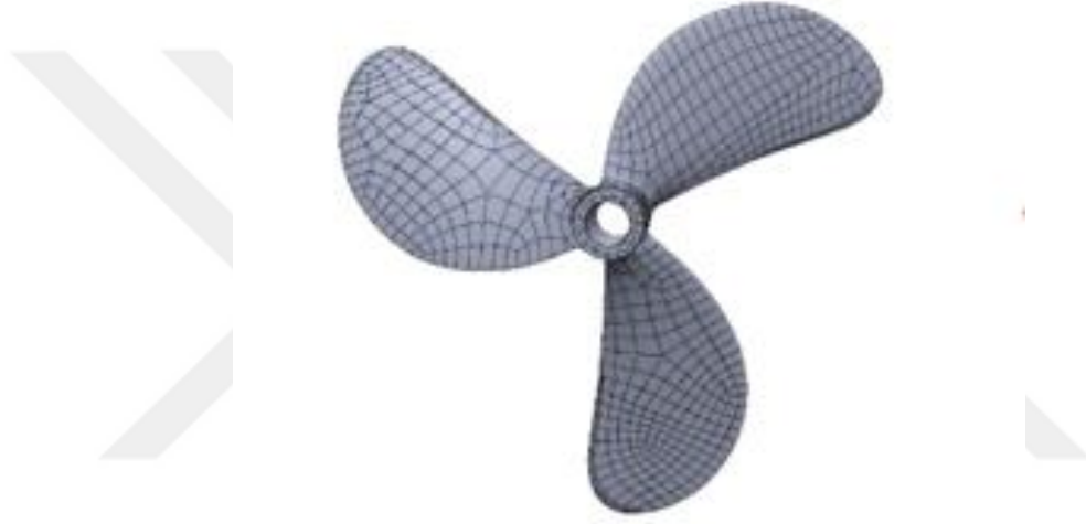
Şekil 2.2 Taranmış Pervane Geometrisi
