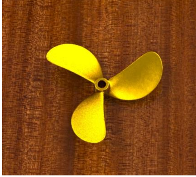
Şekil 3.1 Pervane CAD Geometrisi
