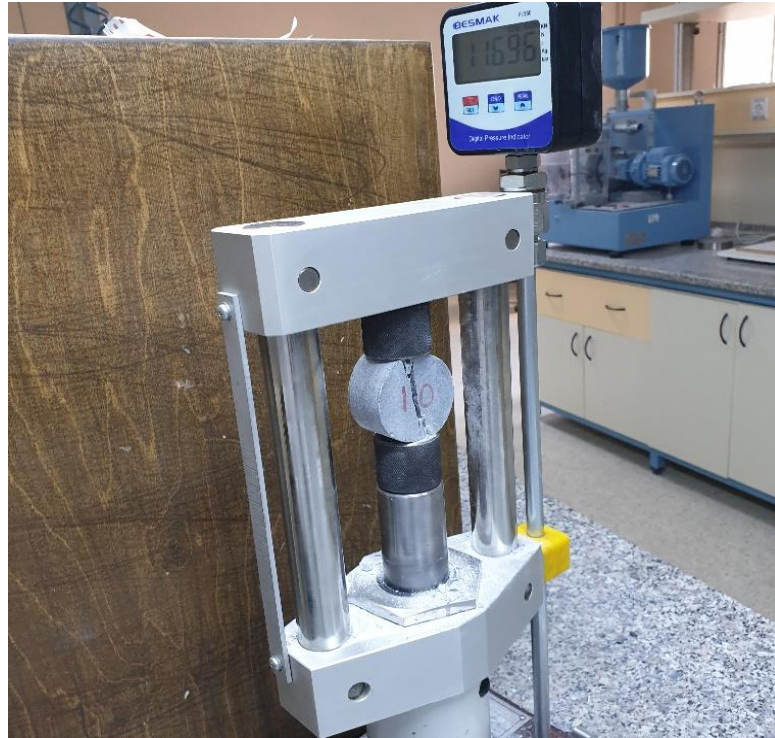
Şekil 4.7 Brazilian indirekt çekme direnci deneyi aleti (Kişisel arşiv, 2019)
