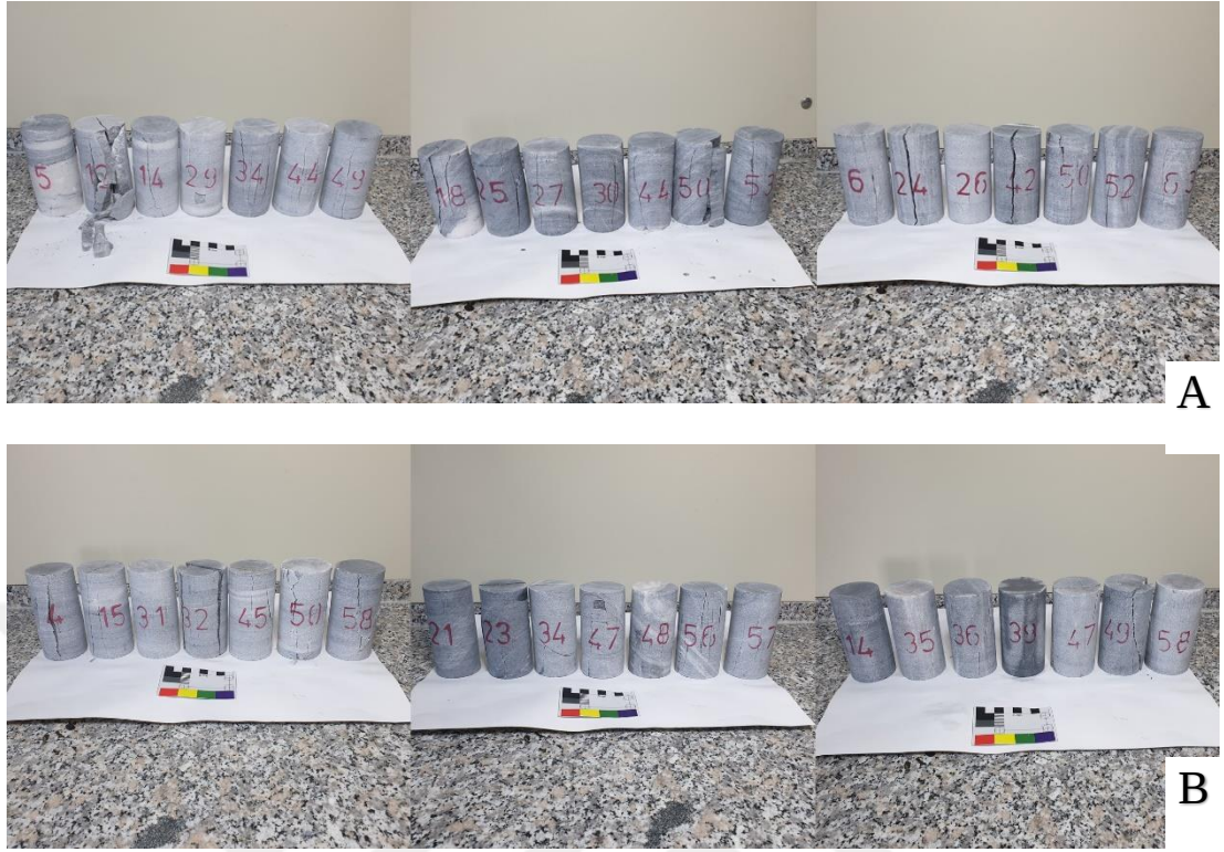
Şekil 4.5 Belevi siyah mermerin kuru (A) ve doygun (B) numunelerin tek eksenli basınç direnci deneyi sonrası görünümü (Kişisel arşiv, 2019)
