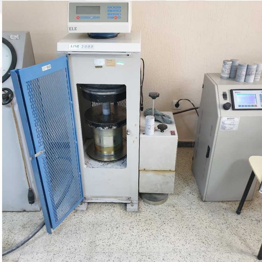
Şekil 4.3 Tek eksenli basınç direnci cihazı (Kişisel arşiv, 2019)
