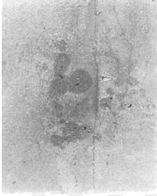
Şekil 4.25 Numune Yüzeyinde Görülen Karınca Hatası Örneği [22]
