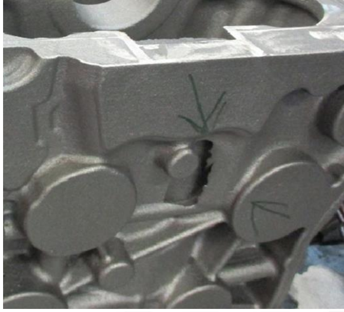
Şekil 4.30 Eksik Döküm Hatalı bir Motor Bloğu Numunesi
