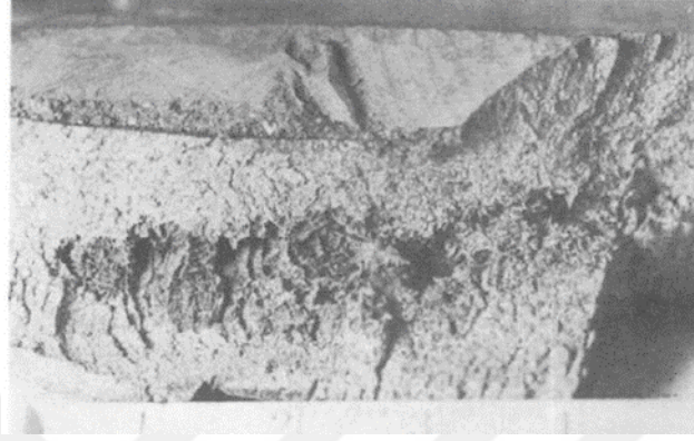
Şekil 4.33 Kalın kesitte besleme hatasına bağlı çekinti boşluğu [22]
