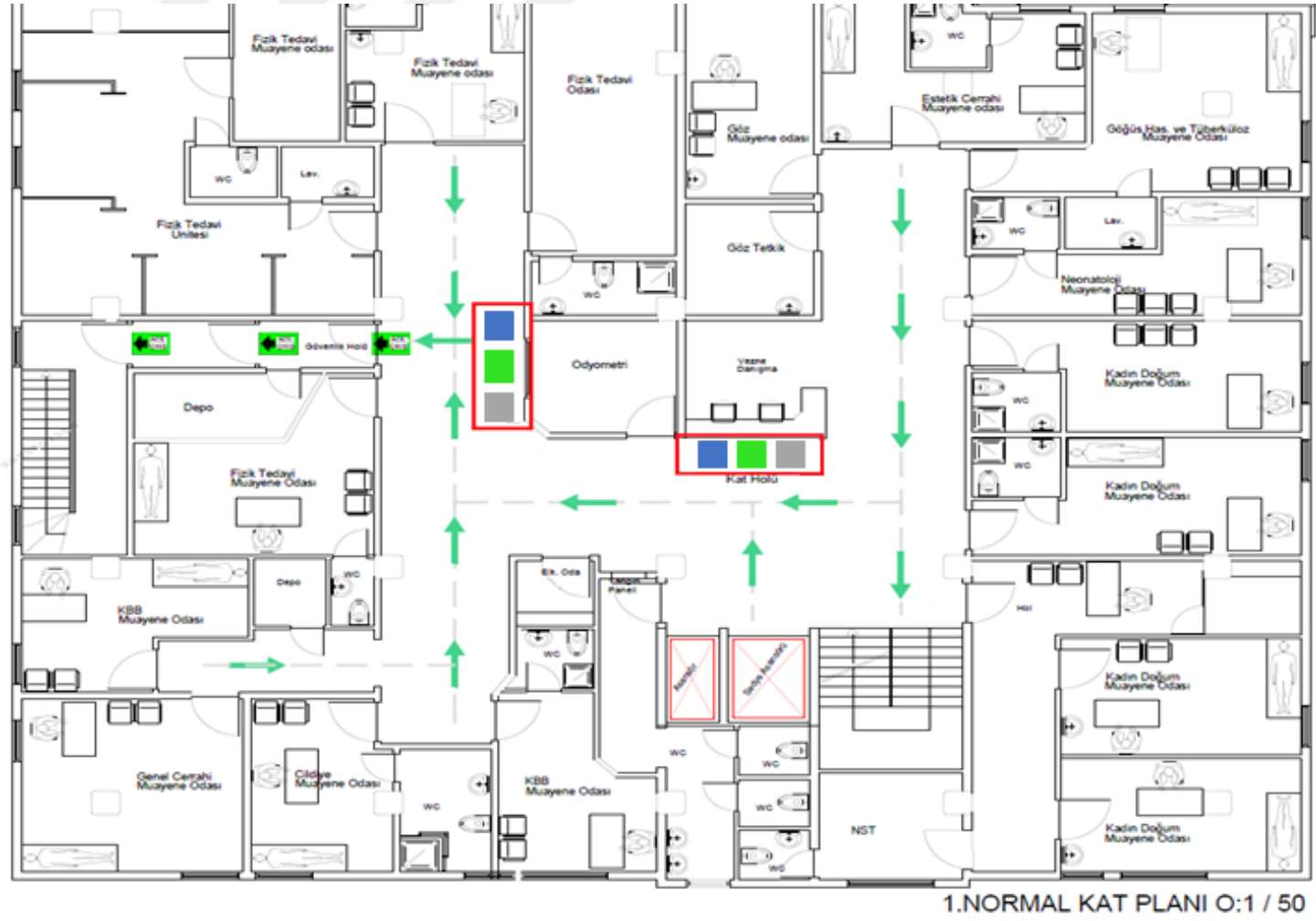
Şekil 8.12 : Delta Hospital 1. Kata Yerleştirilmesi Planlanan Atık Kutuları
