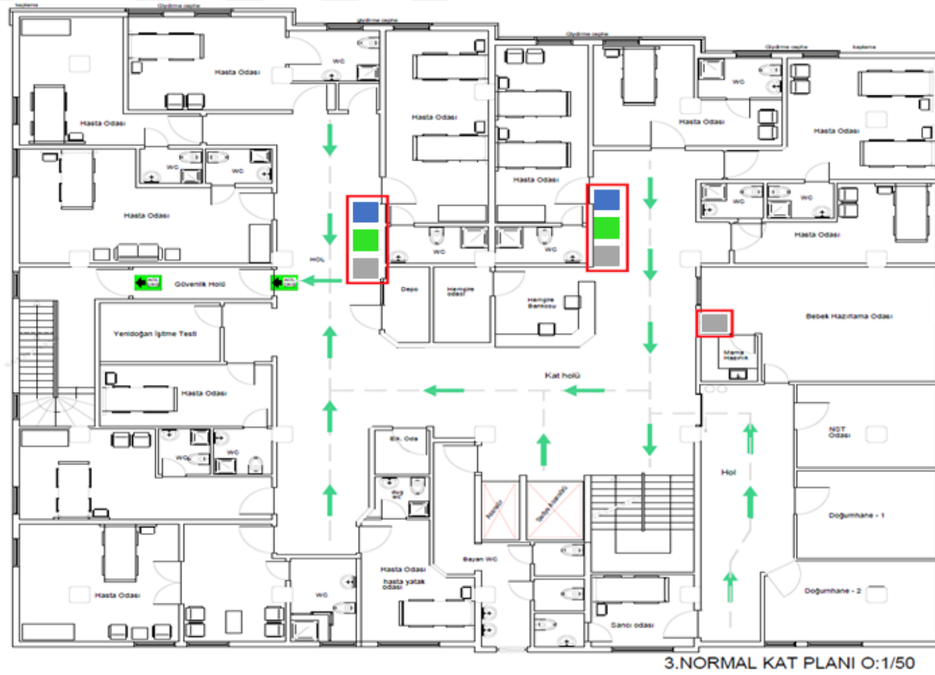
Şekil 8.14 : Delta Hospital 3. Kata Yerleştirilmesi Planlanan Atık Kutuları
