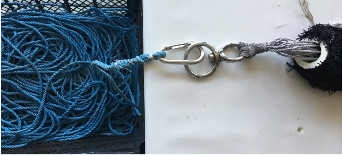
Şekil 6. Çekme halatının ve firdöndünün bağlanma şekli (Orijinal)
