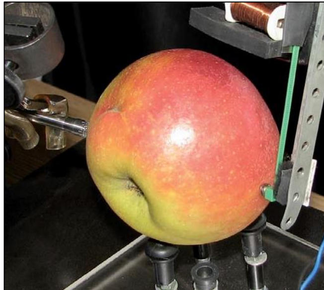
Şekil 2.2 Meyve eti sertliğinin tahribatsız ölçümü düzeneği (Foerster vd. 2010)
