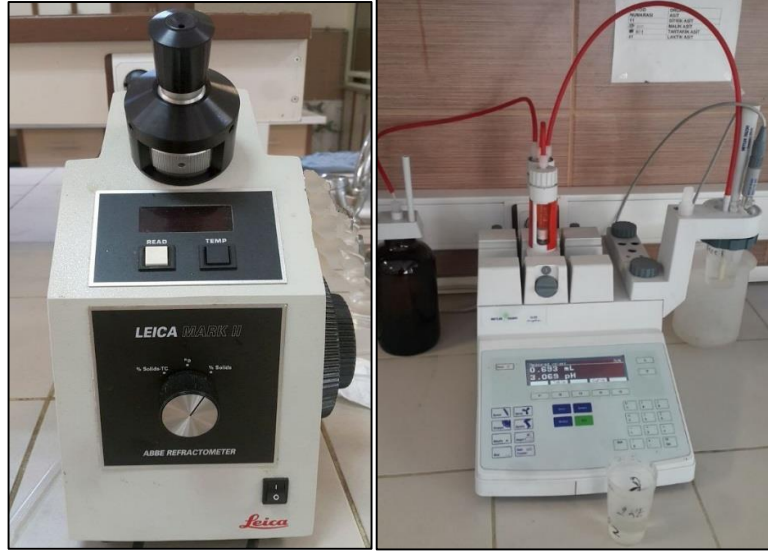
Şekil 3.4 SÇKM ölçümünde kullanılan masaüstü dijital Abbe refraktometre (Leica) cihazı (sol) ve TEA ölçümünde kullanılan otomatik titratör (Mettler Toledo DL50 Graphix) cihazı (sağ)
