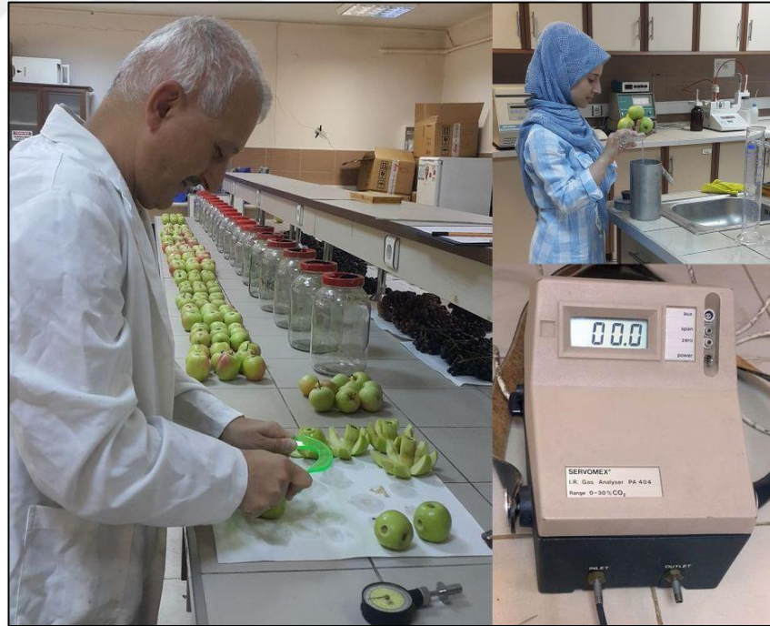
Şekil 3.5 Meyve eti sertliği ölçümü (sol) ve meyve hacmi ölçümü (sağ-üst) ile solunum testinde kullanılan CO 2 analizatörü (Servomex) cihazına (sağ-alt) ait görüntüler
