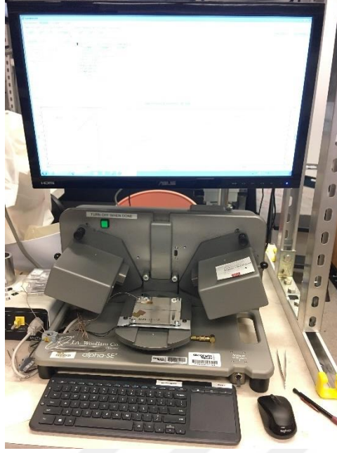
Şekil 3.12. ALD ile kaplama öncesi ve sonrası Si-altlıkların kalınlığını ölçmek için kullanılan elipsometre cihazı
