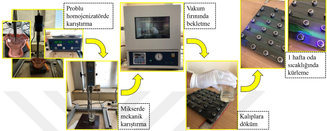
Şekil 3.14. Saf epoksi ve epoksi-ışıldar toz kompozit hazırlama ve kalıba dökme aşamaları
