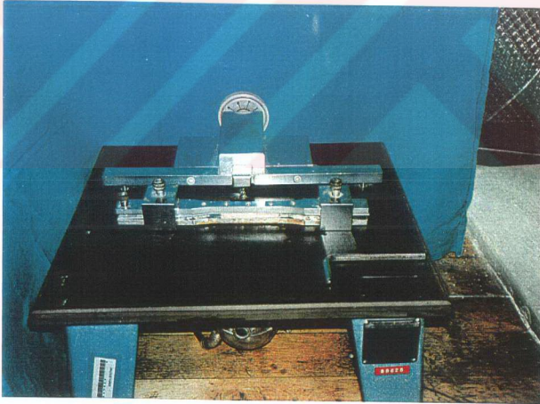
Resim 3.11: Örnek genişliğini azaltmak için kullanılan freze aleti
