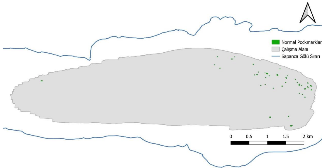
Şekil 5.26: Normal pockmarkların çalışma alanındaki konumlarını gösteren harita. Şekil 5.12'deki kalınlık verisi kullanılarak her pockmarka kalınlık değeri atanmıştır ve en büyük değerler (d) belirlenmiştir. Bu değerler haritada en derin nokta parametresi olarak işaretlenmiştir. Bu noktaların su yüzeyine olan uzaklığı batimetri verisinden alınarak gerçek derinlik değerleri (MaxSD) bulunmuştur. Gerçek derinlik değerinden
