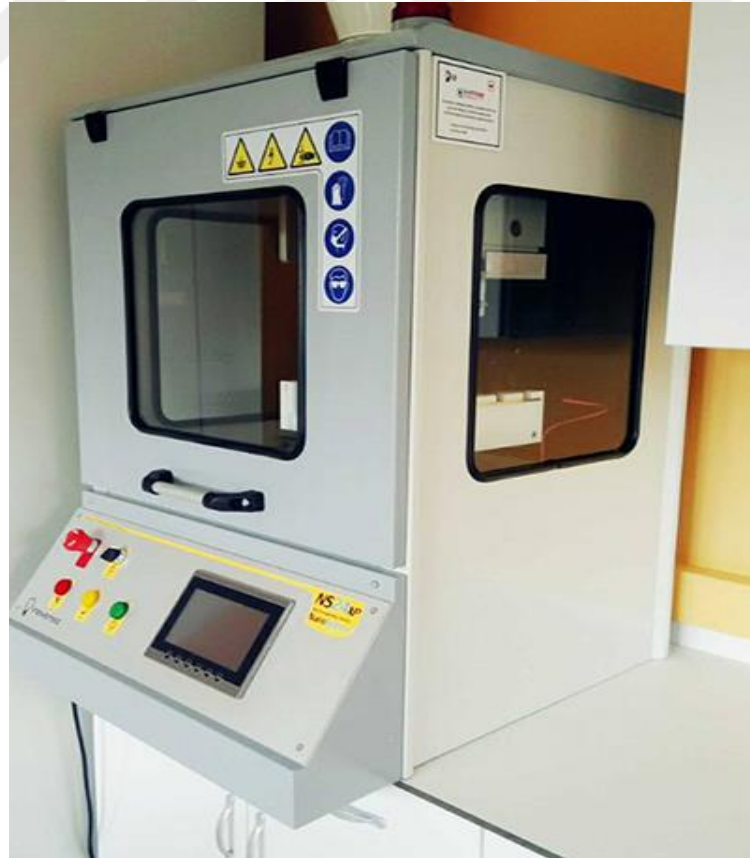
Şekil 2 Üretimde Kullanılan Elektroeğirme Cihazı (Inovenso Marka NS24XPro Model Elektroeğirme Cihazı)
