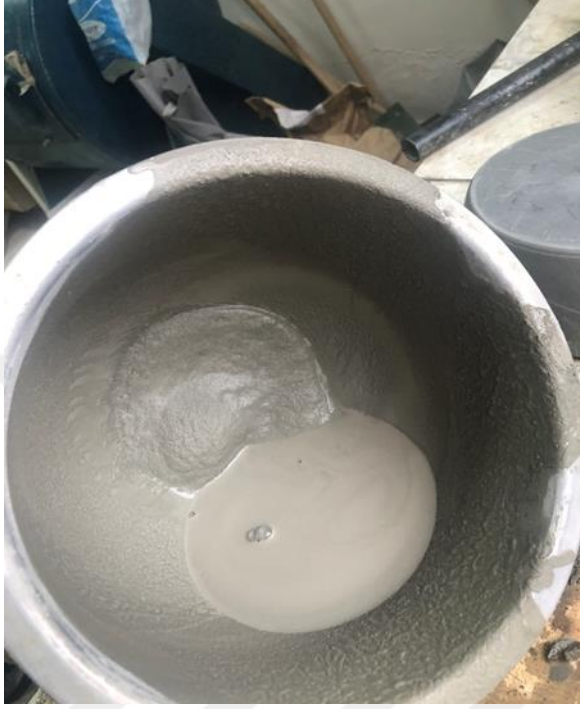
Şekil 3.1. Harçta oluşan segregasyon
