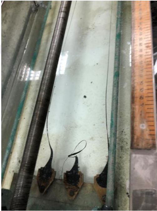
Şekil 3.10. Düktilite deneyi, bitümün koptuğu an
