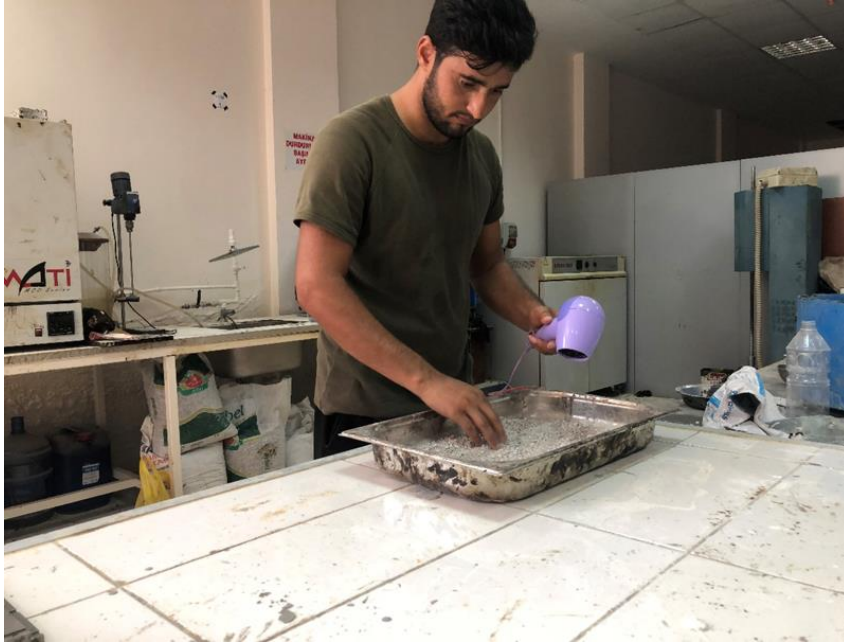
Şekil 3.5. İnce agreganın suya doymuş kuru yüzey hale getirilmesi
