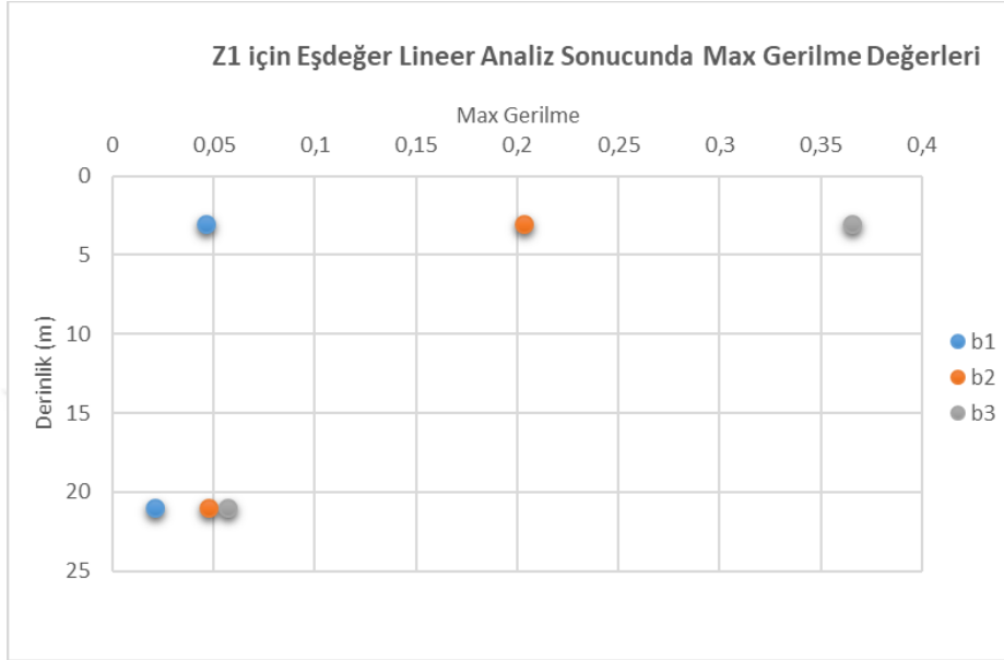
Şekil 63. Evler, Tuğla ve Beton gibi Yapılar için Sınır Değerlerinde Z1'deki Eşdeğer Doğrusal Analiz Sonuçlarında Maksimum Gerilme Değerleri
