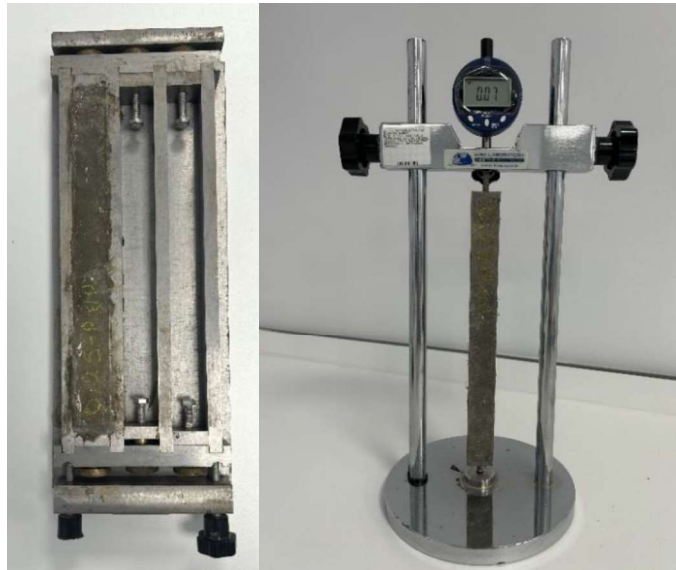
Şekil 3.17 Kuruma rötresi deney düzeneği.
