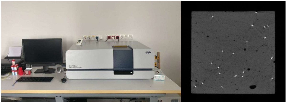
Şekil 3.23 Bilgisayarlı Mikro Tomografi cihazı ve örnek görüntü.
