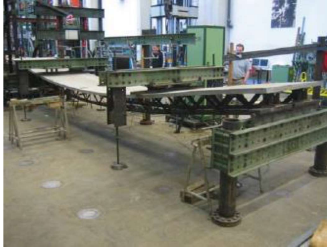
Şekil 2.11 Kompozit ECC panelin yük-deplasman testi (Li, 2019).
