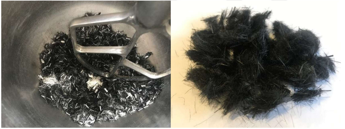
Şekil 3.7 PVA liflerin nano grafit ile kaplanması.
