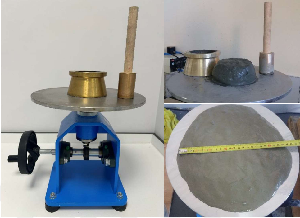
Şekil 3.11 Mini yayılma tablası deneyi.
