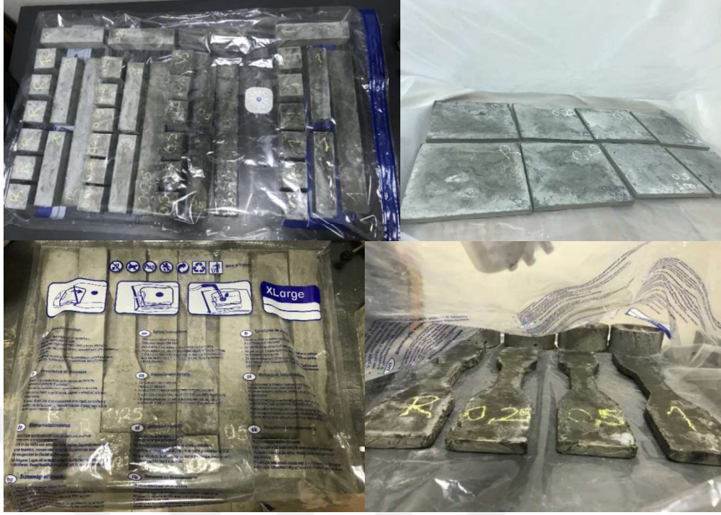
Şekil 3.10: Numunelerin kür işlemi.
