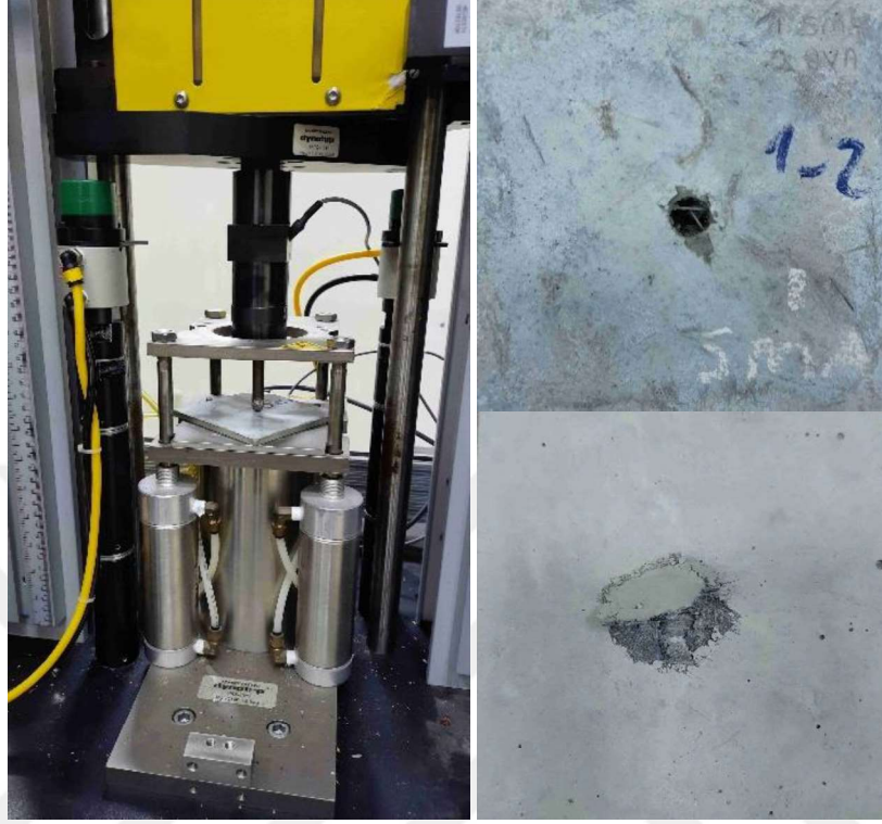
Şekil 3.19 Ağırılık düşürmeli düşük hızlı çarpma deneyi.
