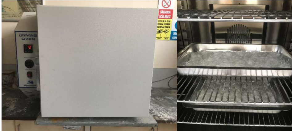
Şekil 3.5 PVA liflerin epoksi ile kaplama sonrası kurutulması.
