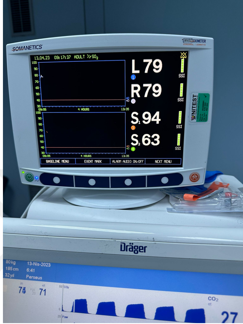
Şekil 3: NIRS monitorizasyon cihazı
