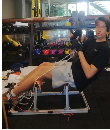
Şekil 8.İskota halatı çekme kuvvet testi yandan görünüm
