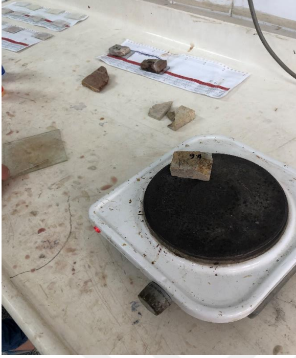
Şekil 3.4. Taş ısıtma işlemi.
