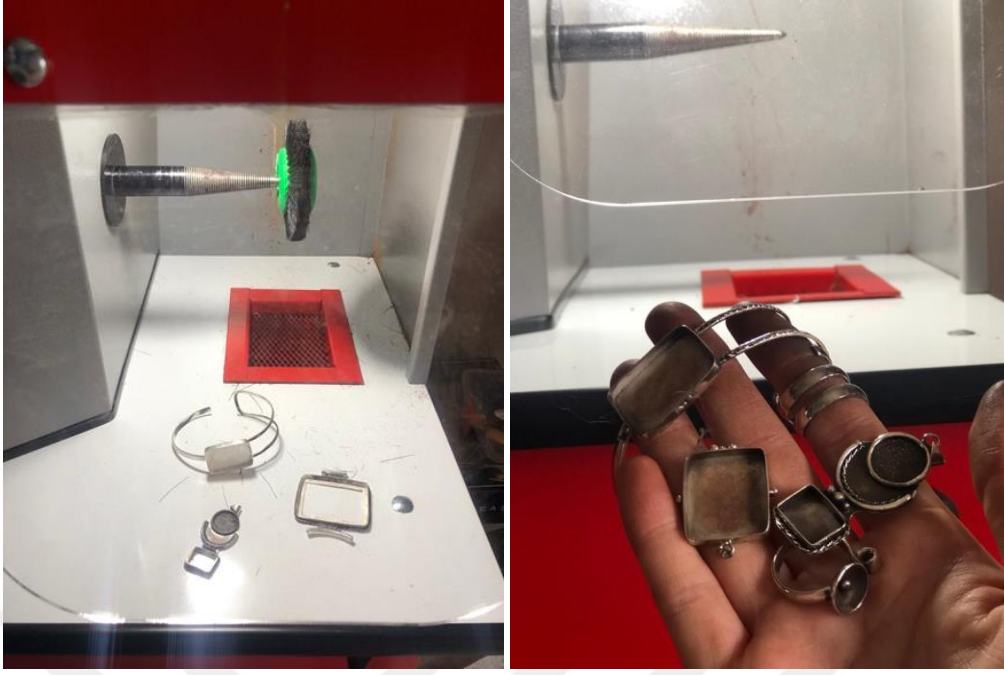
Şekil 3.19. Cila işlemi aşamaları.
