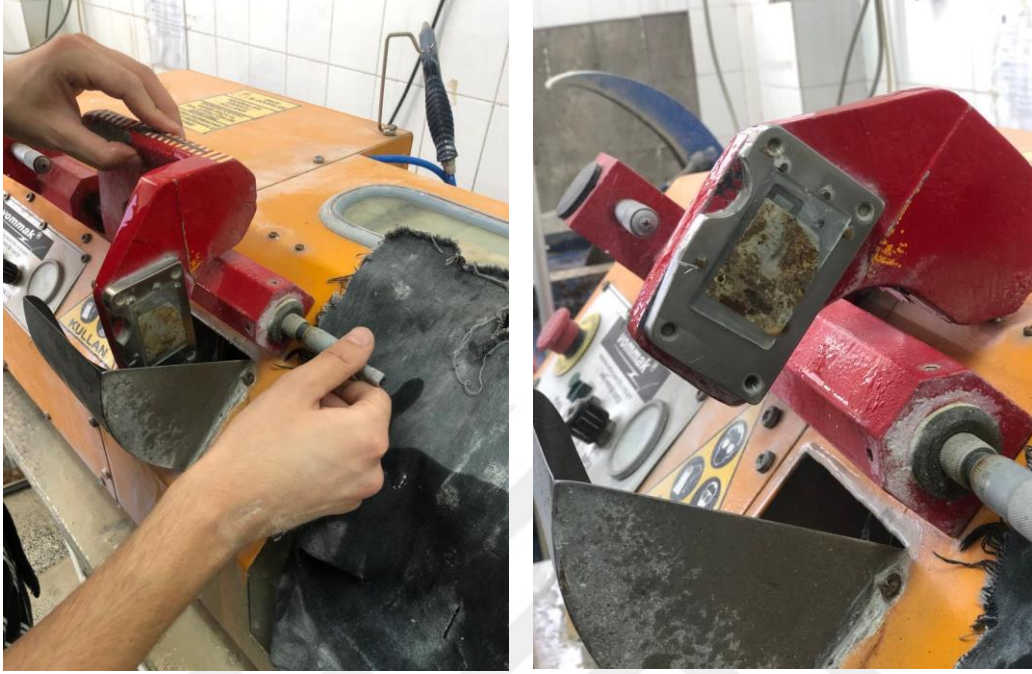
Şekil 3.7. Örneklerin vakumlu taş kesme makinasında inceltilmesi.
