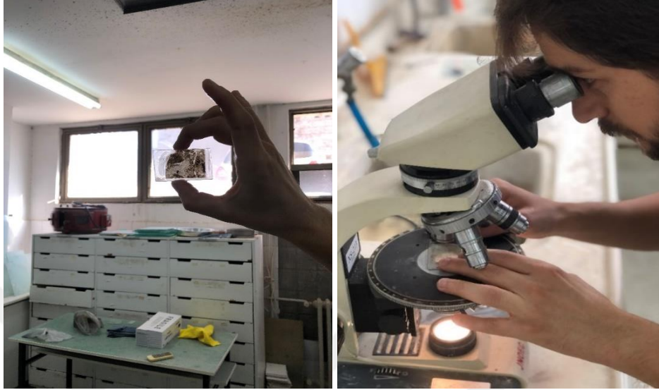
Şekil 3.9. Örneklerin petrografik incelemeye hazır hale getirilmesi.
