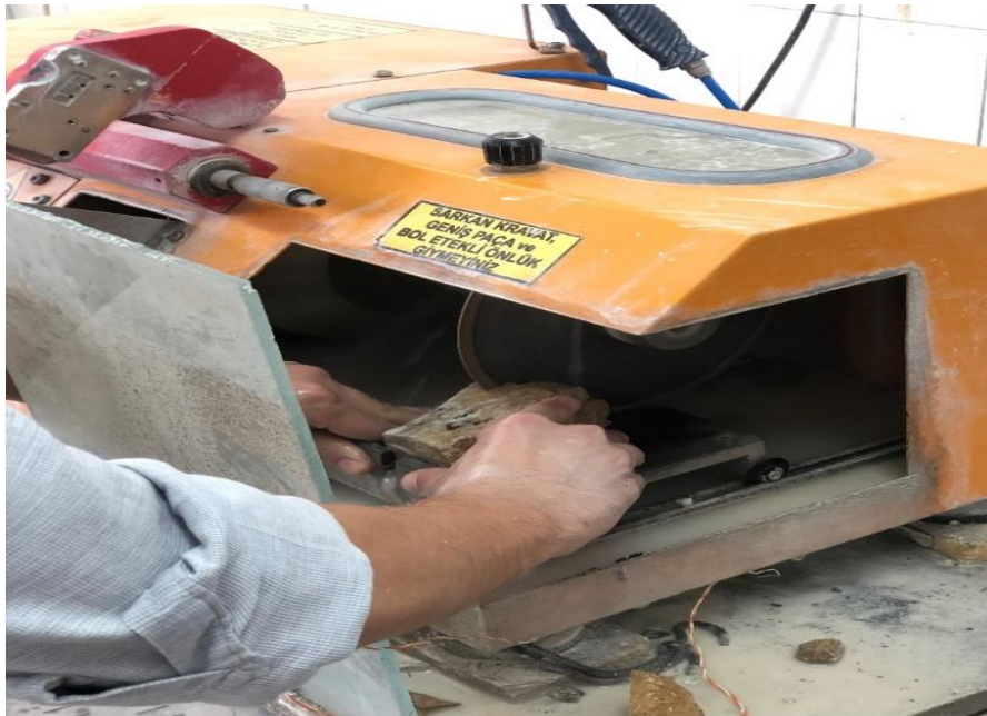
Şekil 3.2. Taş kesme makinesi ile dilim alma işlemi.
