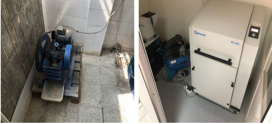
Şekil 3.10. Kırma ve öğütme işlemleri için kullanılan çeneli kırıcı ve öğütücü.
