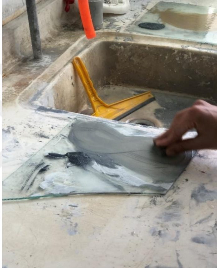
Şekil 3.3. Taş yüzeyi zımparalama işlemi.
