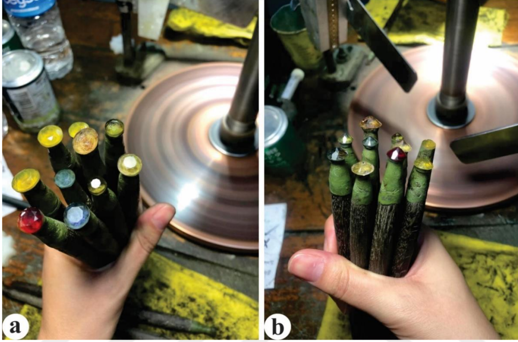
Şekil 2.2. Gamze ÖZNALÇİN, Mücevher İhracatçılar Birliği Taş Kesim Atölyesi, 2021. Taşların tabla yüzeyine uygulanan faset kesim uygulama aşaması (a), Taşların külah kısmına uygulanan faset kesim uygulama aşaması (b).
