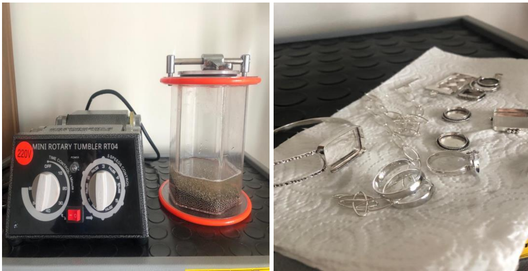
Şekil 3.20. Tambur makinası ve temizliği yapılmış ürünler.
