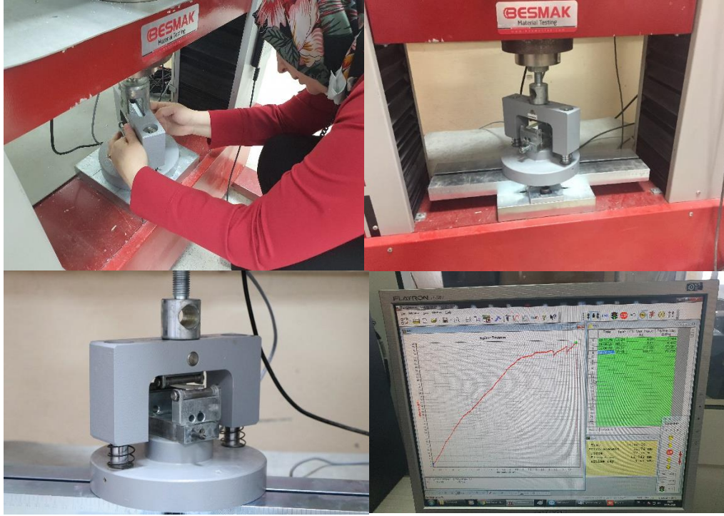
Şekil 3.19. Eğilme dayanımı deney düzeneği.
