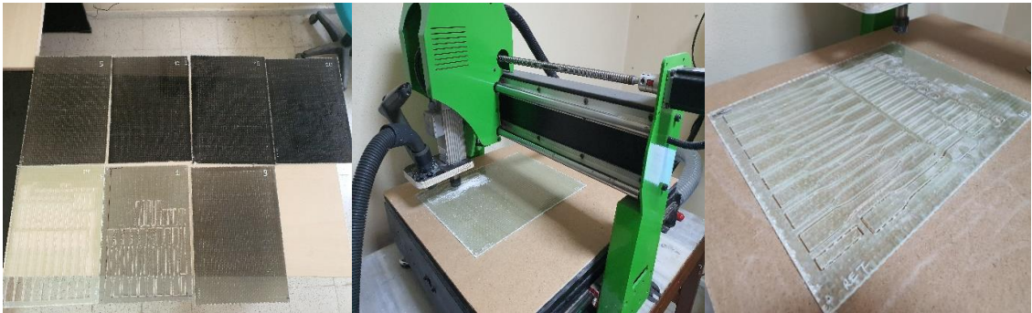
Şekil 3.8. Üretil en GNT takviyeli kompozitler ve deney örneklerinin kesilmesi.
