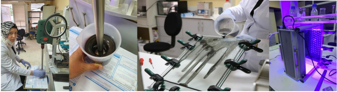
Şekil 3.7. GNT takviyeli kompozit karışımların cam kalıplar arasında LED/UV kürl em e prosesi.
