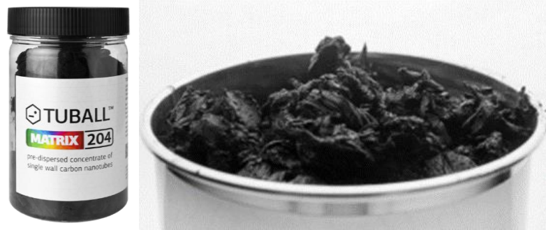
Şekil 3.2. Kompozit üretiminde kullanılan GNT nin kolay disperse edilebilir formu.
