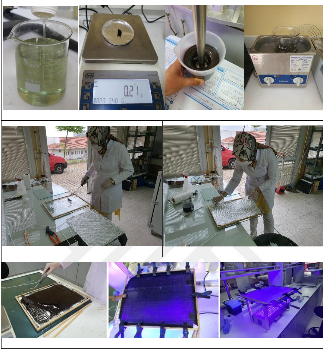
Şekil 3.10. GNT+Cam elyaf takviyeli kompozitlerin üretim görselleri.
