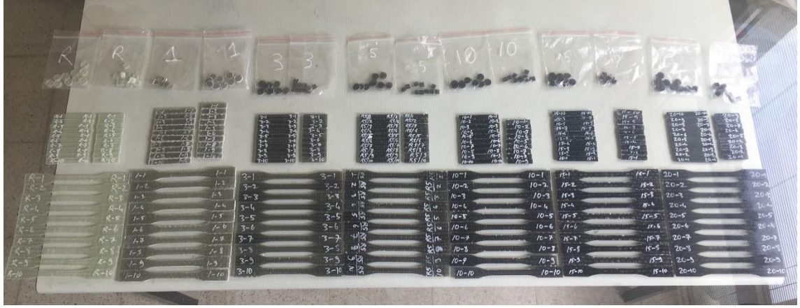
Şekil 3.11. Üretimi yapılan GNT+Cam elyaf takviyeli kompozitlerden CNC ile kesilen numuneler.
