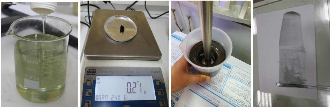
Şekil 3.5. GNT takviyeli LED ile kürlenene polyester reçine karışımlarının hazırlanması.
