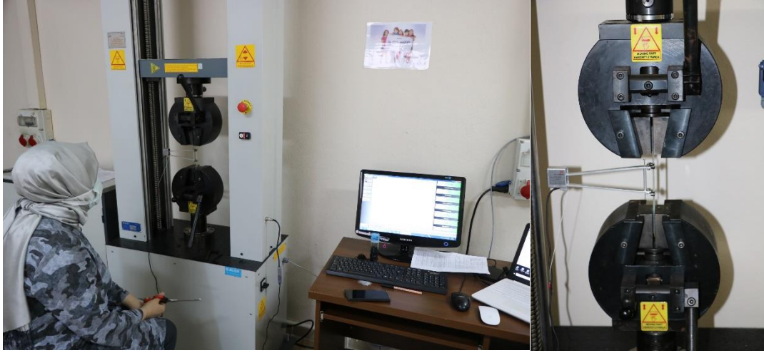
Şekil 3.18. Çekme dayanımı deney düzeneği.
