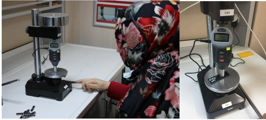
Şekil 3.21. Shore-D sertlik cihazı ile ölçümlerin yapılması.
