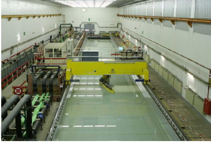
Şekil 2.3 : Çekme tankı mekanizması (Delefortrie ve diğ, 2016).
