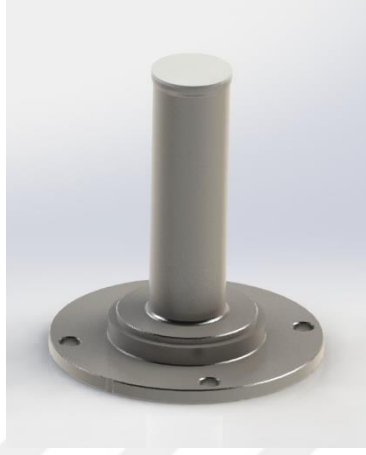
Şekil 2.18 Testlerde kullanılacak soğuk parmak kılıfı 3D katı model görseli
