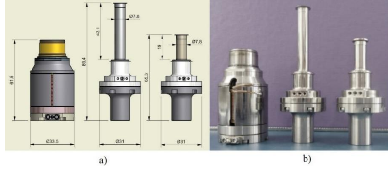
Şekil 2.19 Farklı tasarımlarda soğuk parmak örnekleri (Veprık vd., 2015)
