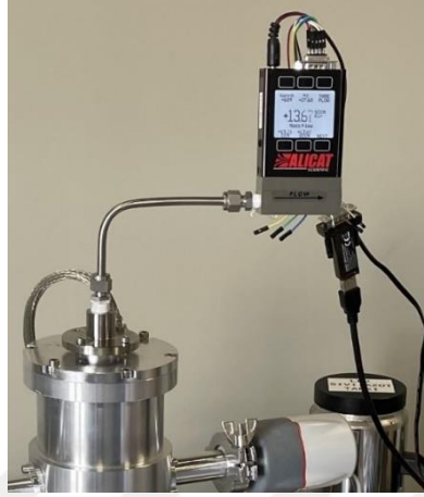
Şekil 3.16 Alicat/M500 kütle akış ölçer (MFM)-test odası montaj görseli
