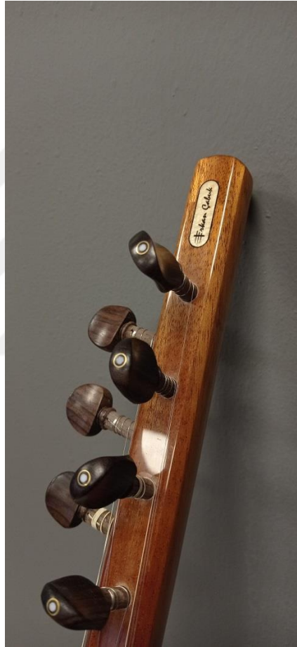
Şekil 3.2- Burguluktaki “Erkan Çabuk” logosu ve 45 derece eğimli burguluk kenarları (İzmir/Bornova, 08.09.2022).
