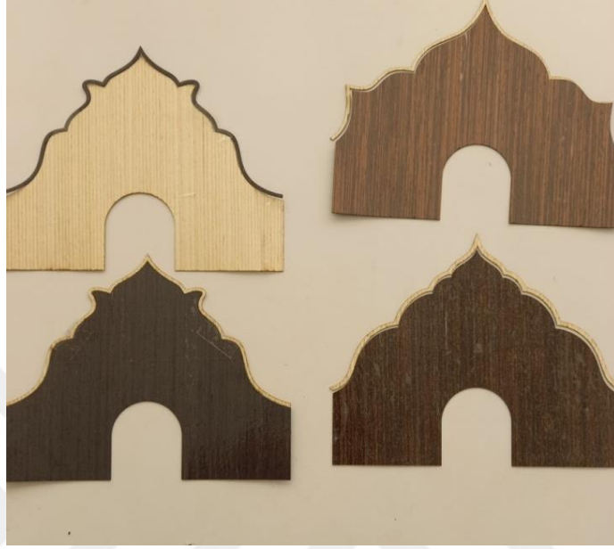
Şekil 3.35- “Etek” ya da “kaplama” olarak adlandırılan parça (Abdullah Öztoprak Kişisel Fotoğraf Arşivi, 2021).
