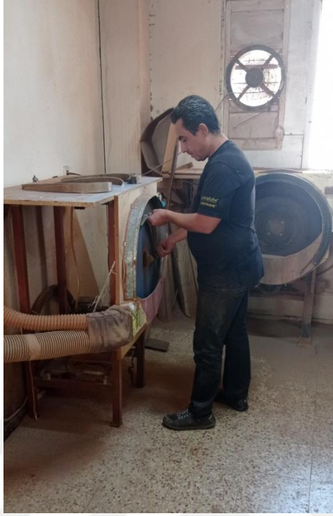
Şekil 3.31- Bilal Öztürk daire zımpara da tekne yapraklarını zımparalıyor (İzmir/Koyundere, 06.10.2022).
