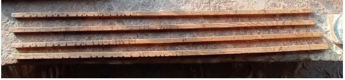
Şekil 3.27- Perde ( fret ) yerlerinin işaretlendiği farklı tel boylarına göre şablon çıtalar (İzmir/Karabağlar, 03.01.2023).
