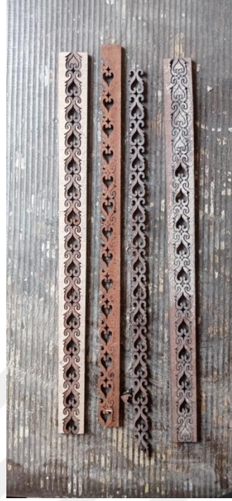
Şekil 3.24- Lazer kesim ile kesilmiş klavye için süslemeler (İzmir/Karabağlar, 07.11.2022).
