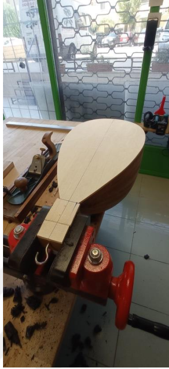
Şekil 3.7- Ölçülendirme ve sap takılma aşamasındaki bir tekne (İzmir/Bornova, 07.09.2022).
