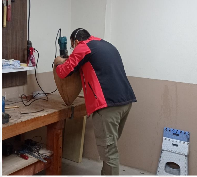
Şekil.3.6- Freze ile gömme yuvası açılıyor (İzmir/Bornova, 23.09.2022).
