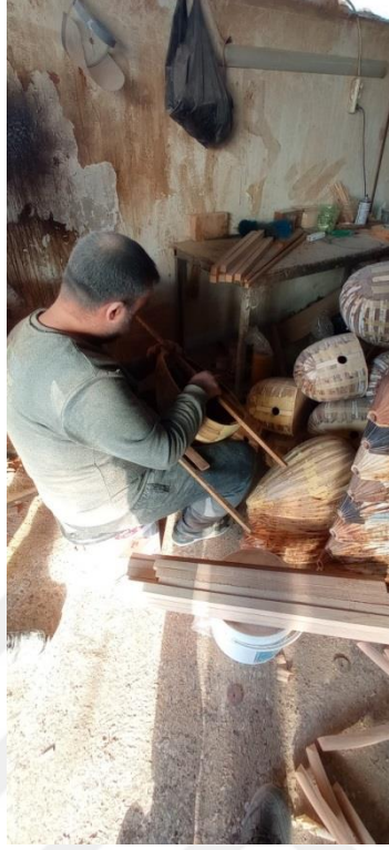
Şekil 3.28- Tekneler için sap oranlaması yapılırken (İzmir/Karabağlar, 03.01.2023).
