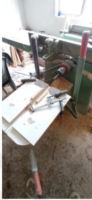
Şekil 3.19- Aslan'ın sap ve tekne için kullandığı kavela geçme yapım aparatı (İzmir/Karabağlar, 07.11.2022).
