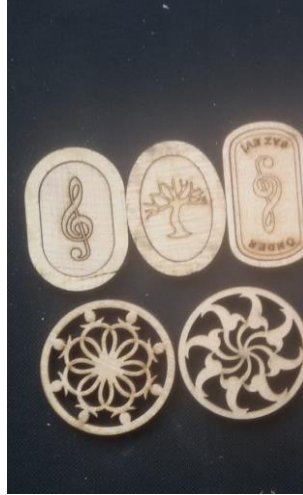
Şekil 3.36- Lazer kesim ile kesilmiş ses kapakları (üsttekiler) ve kafesler (alttakiler) (Abdullah Öztoprak Kişisel Fotoğraf Arşivi, 2021).
