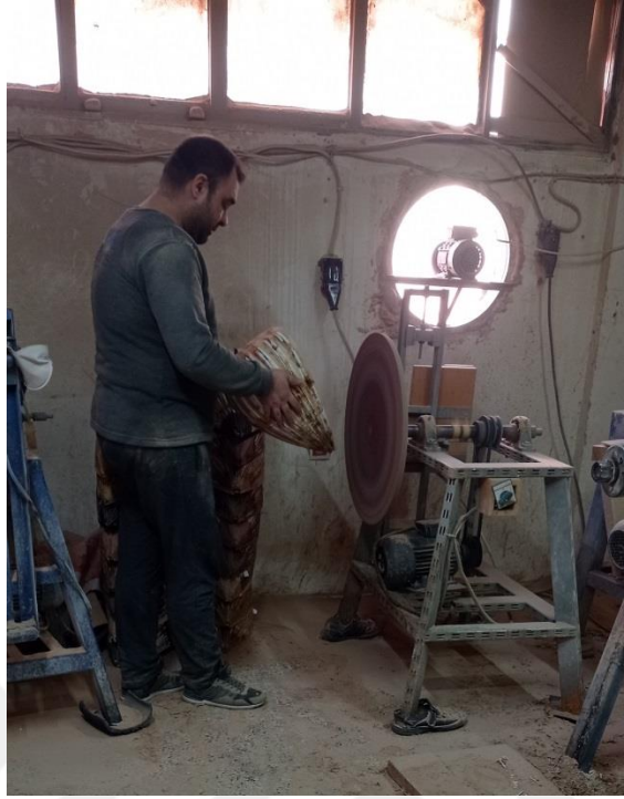
Şekil 3.26- Bağlama teknesinin kapak yüzeyi daire zımpara işleminde (İzmir/Karabağlar, 03.01.2023).
