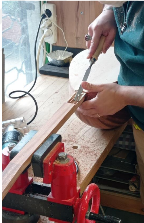
Şekil 3.9- Aynalık yuvası, freze işleminden sonra ıskarpela ile temizleniyor (İzmir/Bornova, 12.10.2022).
