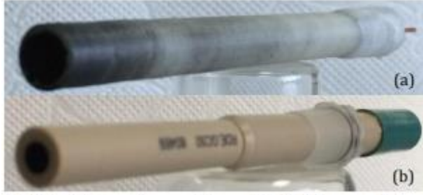
Şekil 2-8 a) Laboratuvar koşullarında hazırlanan CPE, b) CPE' un Ticari olarak satılanı.
