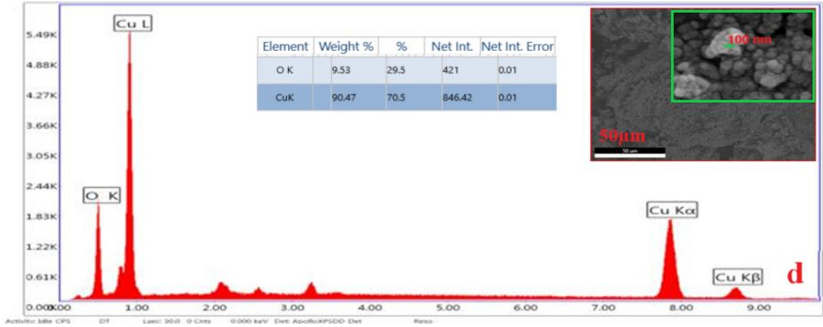
Şekil 4-6 CuO NP' lerin EDS Enerji Dispersiv Spektrumu ve SEM görüntüsü.
