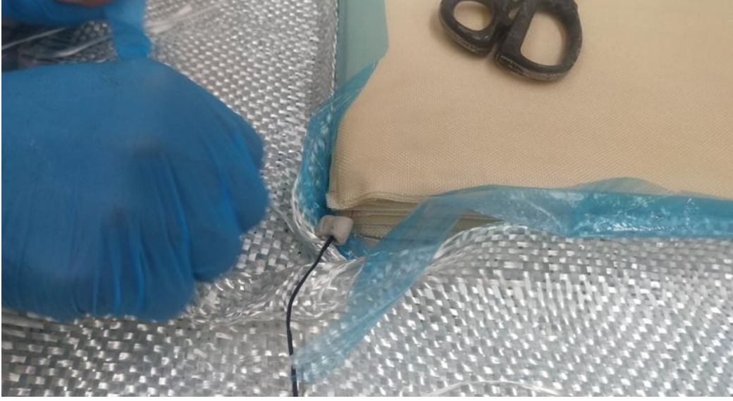
Şekil 4.18 Parçanın köşelerinden yerleştirilen ısı çift görüntüsü.
