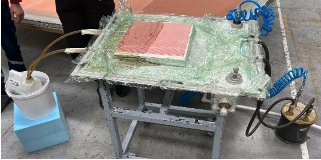
Şekil 4.30 Benzoksazin matrisli, yüksek silika takviyeli kompozit plaka VARTM düzeneği: sol taraf reçine besleme hattı, sağ taraf vakum hattı.
