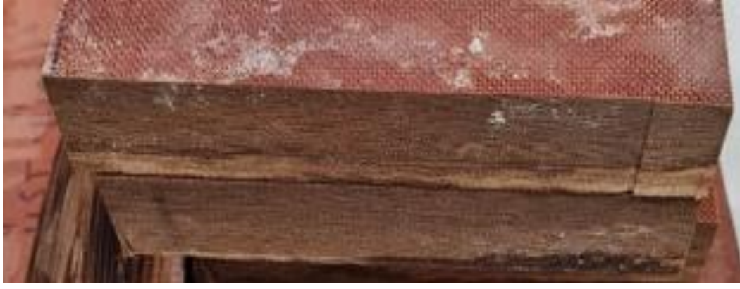
Şekil 4.29 VARTM metodu ile üretilmiş, fenolik reçine matrisli, yüksek silika takviyeli ablatif özellikli kompozit plaka, arayüz görüntüsü.
