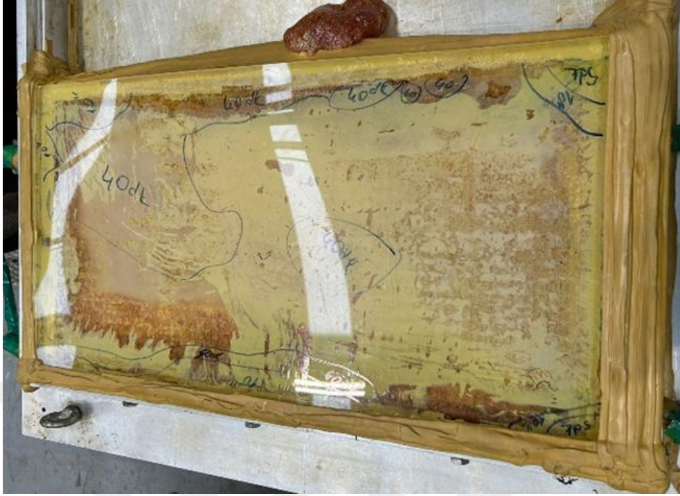
Şekil 4.46 Otoklavdan çıkan kalıp içerisindeki parçanın görüntüsü.
