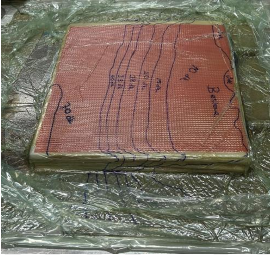
Şekil 4.32 Reçine emdirme operasyonunun tamamlanması.
