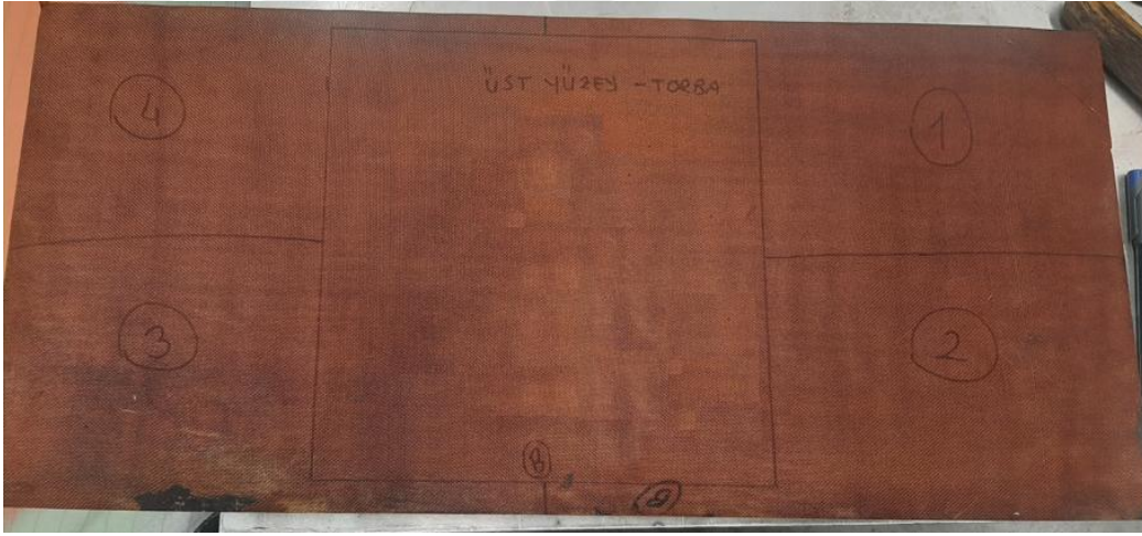
Şekil 4.28 VARTM metodu ile üretilmiş, fenolik reçine matrisli, yüksek silika takviyeli ablatif özellikli kompozit plaka, üstten görünümü.
