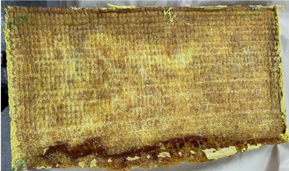
Şekil 4.47 Fenolik reçine matrisli, seramik battaniye takviyeli ablatif özellikli kompozit malzeme üst yüzey görüntüsü.
