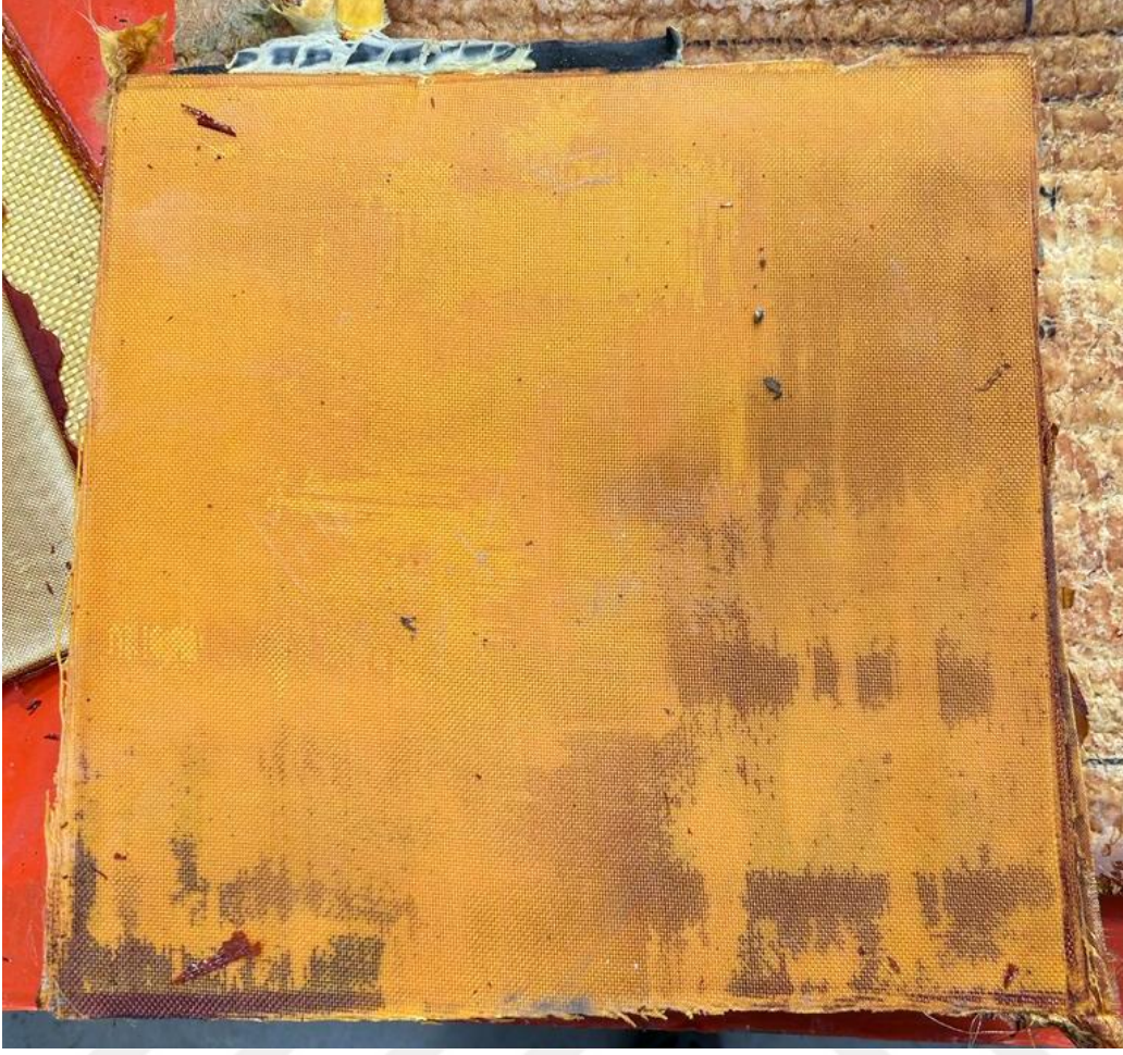
Şekil 4.36 Benzoksazin matrisli kompozit plaka taban görüntüsü.
