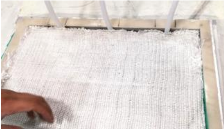
Şekil 4.11 Preform ve besleme/vakum portlarının kalıba yerleştirilmesi görseli.
