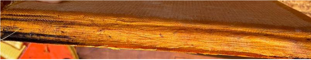
Şekil 4.37 Benzoksazin matrisli kompozit plaka arayüz görüntüsü.
