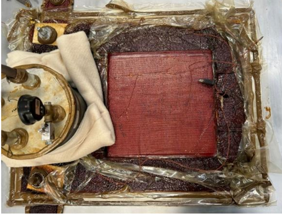
Şekil 4.34 Otoklav sonrası parça ve kalıp görüntüsü.
