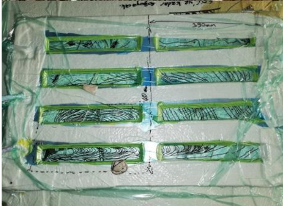
Şekil 4.14 VARTM metodu ile fenolik reçine beslemesi.
