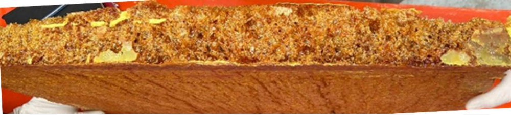
Şekil 4.49 Fenolik reçine matrisli, seramik battaniye takviyeli ablatif özellikli kompozit malzeme arayüz görüntüsü.
