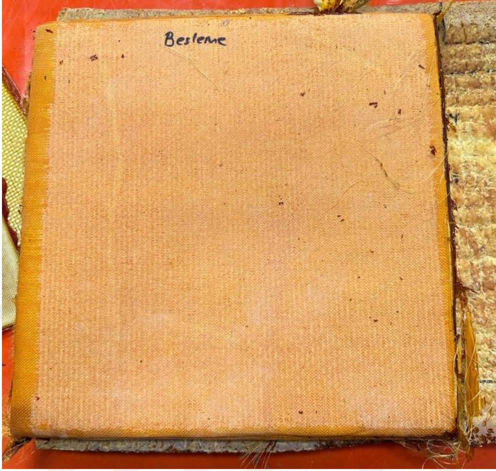
Şekil 4.35 Benzoksazin reçine matrisli kompozit plaka üstten görünümü.
