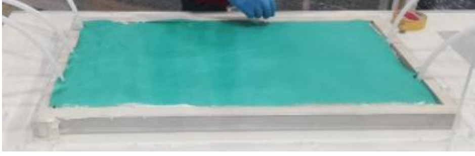
Şekil 4.12 Preform üzerine soyma kumaşı yerleştirilmesi görseli.
