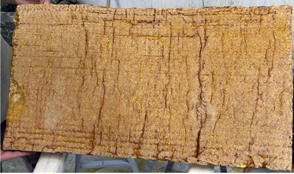
Şekil 4.48 Fenolik reçine matrisli, seramik battaniye takviyeli ablatif özellikli kompozit malzeme alt yüzey görüntüsü.
