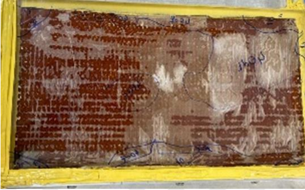
Şekil 4.44 Reçinenin battaniyeye tamamen emilmesi sonucu ürün görseli.
