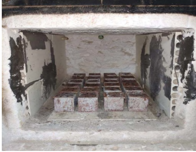
Şekil 3.9: Kül fırınına yerleştirilen numuneler
