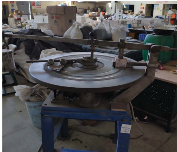
Şekil 3.7: Böhme aşınma deneyi
