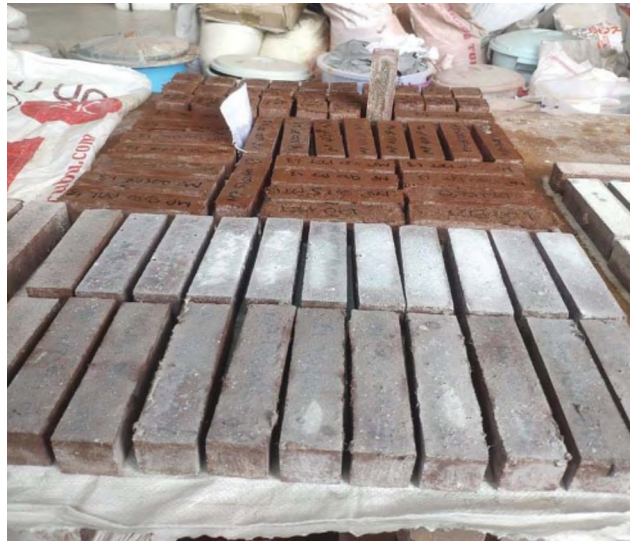
Şekil 3.11: Sülfat etkisindeki numuneler
