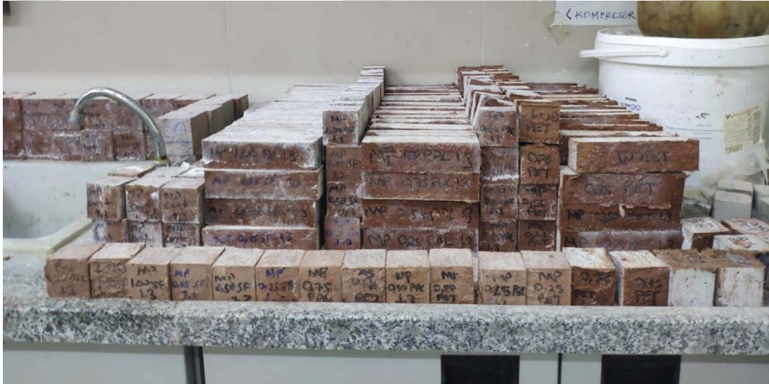
Şekil 3.12: Üretilen tüm geopolimer harçları
