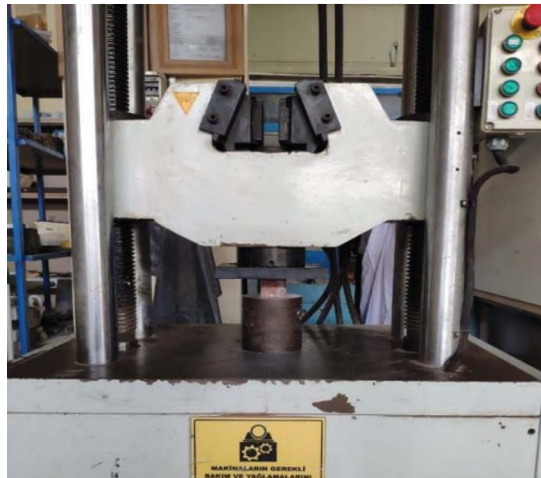
Şekil 3.4: Basınç dayanımı uygulaması
