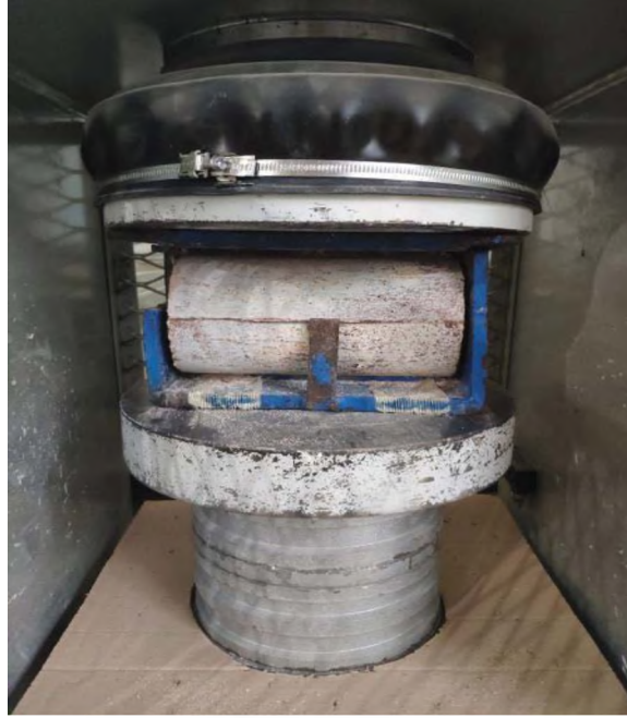
Şekil 3.6: Yarmada Çekme Deneyi
