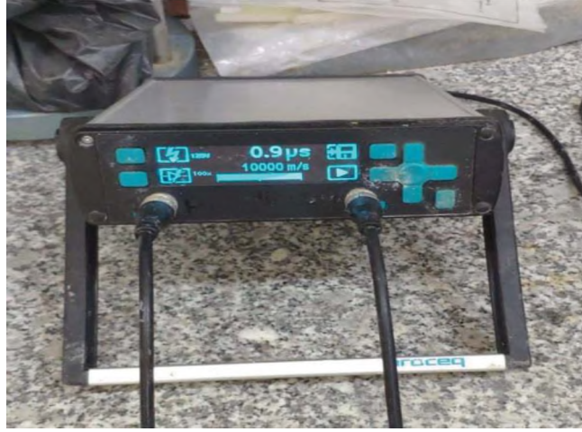
Şekil 3.8: Ultrases geçiş hızı testinde kullanılan cihaz
