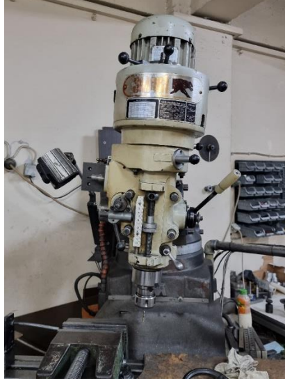
Resim 5.28. Smart marka freze cihazına 5 derece eğim verilmiş hali
