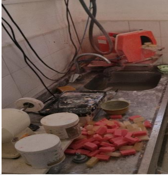
Resim 5.14. Üretilen akrilik blokların çapak kısımlarının trim ile düzeltilmesi
