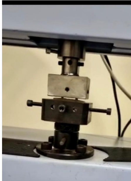
Resim 5.36. Universal test cihazın alt ve üst bölümünün modellere bağlanması
