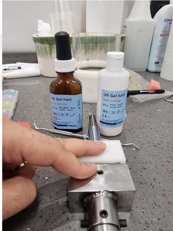
Resim 5.32. Ufi Gel Hard ile matrixlerin akrilik bloklara bağlanması yandan görüntüsü
