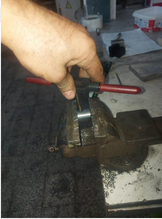
Resim 5.24. Mengeneye sıkıştırılan çelik silindere vida deliği olukları açma
