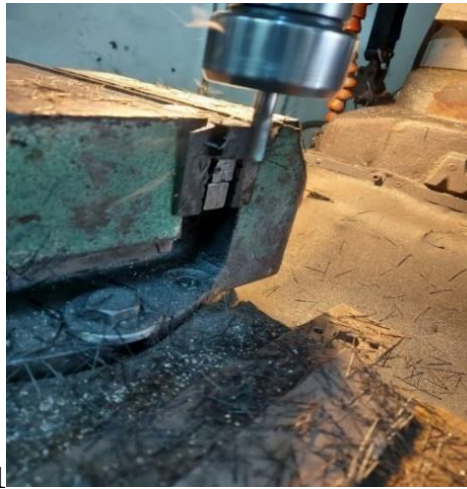
Resim 5.8. Kestamit blok torna tezgahında şekillendirilirken
