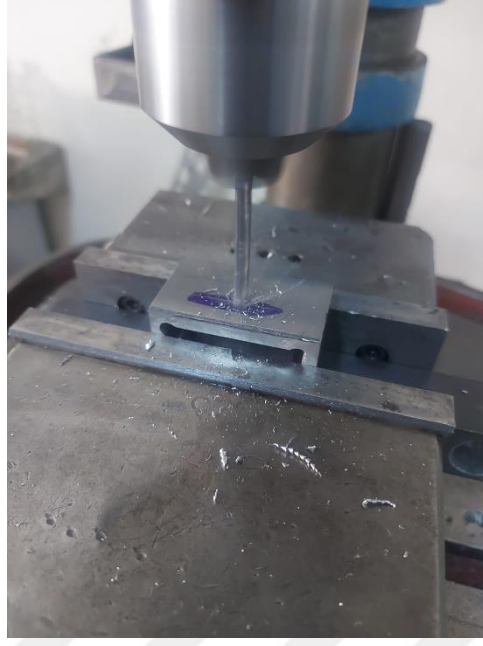
Resim 5.25. Çelik prizmatik havuza matkap cihazı ile oluk açma
