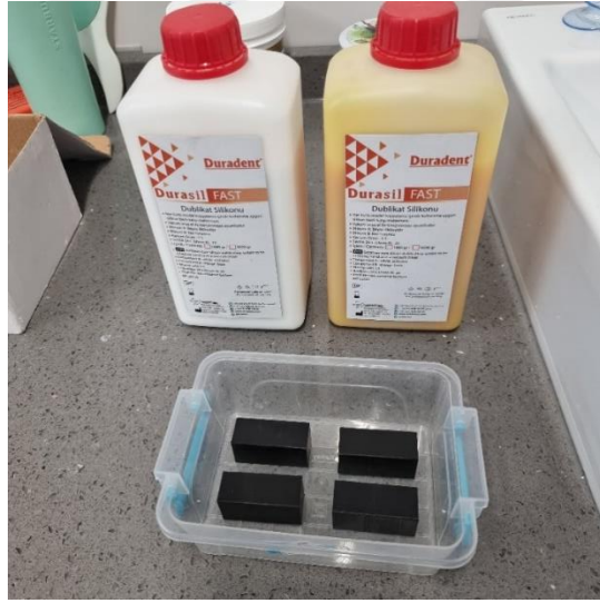
Resim 5.10. Kestamit blokların dublikatörün döküleceği kaba koyulması
