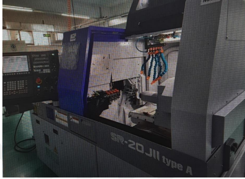
Resim 5.3. STAR Marka SR 20JII TypeA modeli CNC Kayar Otomat Makinesi
