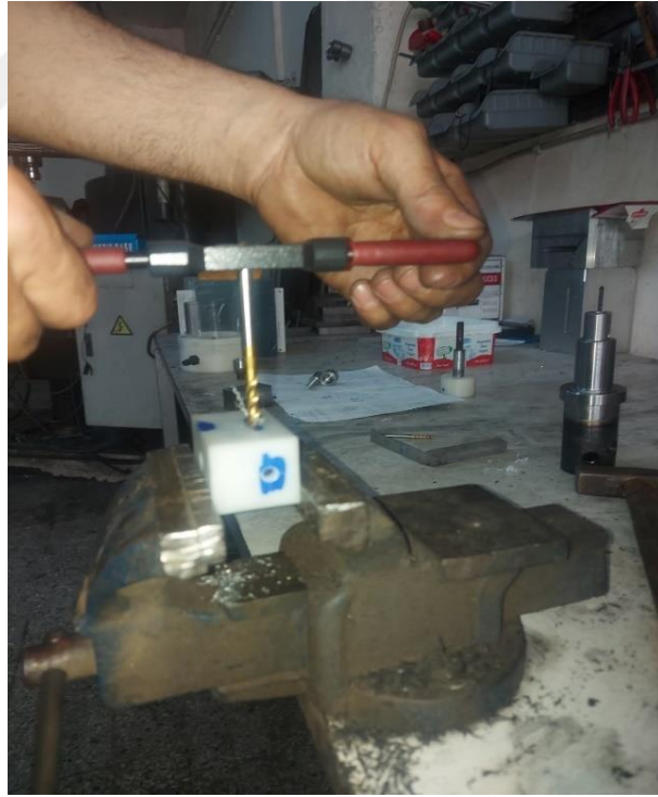
Resim 5.18. Derlin parçasına vida deliği oluşturulması
