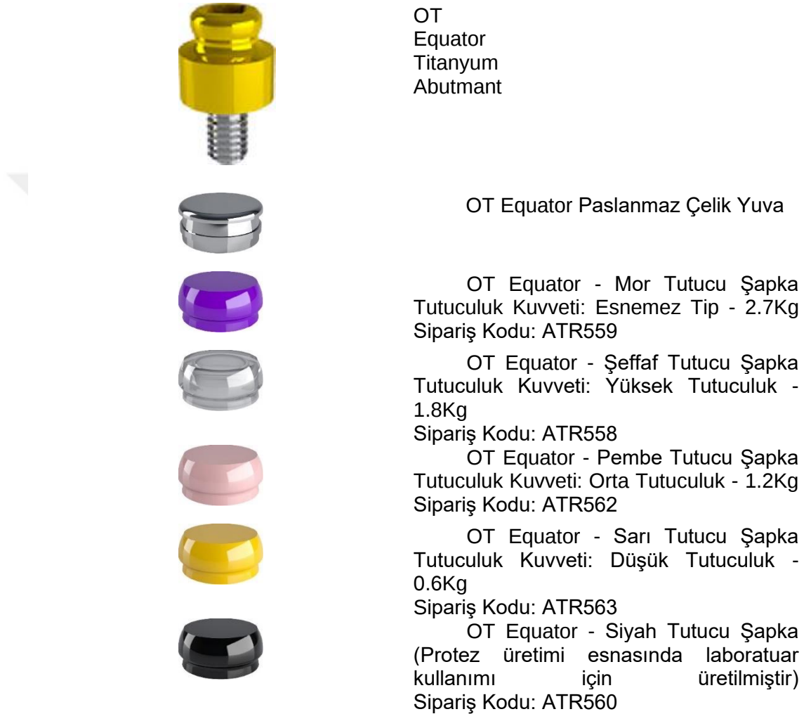
Şekil 4.24. Rhein 83 OT Equator patrix ve matrix parçalarının özellikleri
