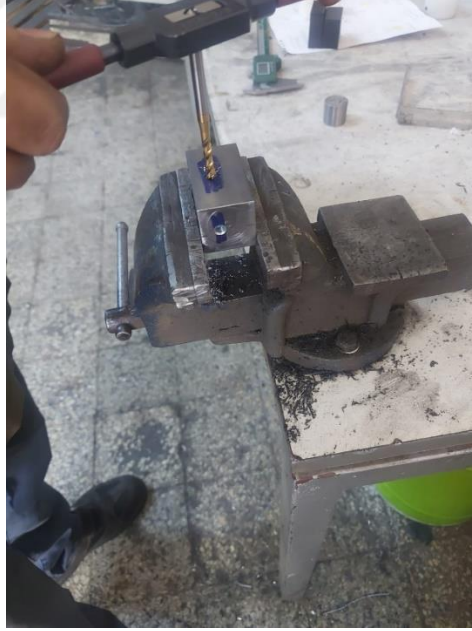
Resim 5.26. Mengerneye sıkıştırılan çelik silindirik havuzun vida oluklarının açılması
