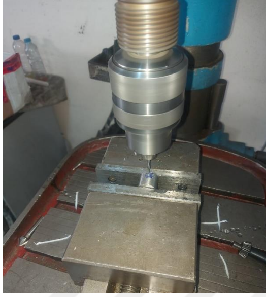
Resim 5.23. Şahin marka matkap cihazı vida yuvası açma
