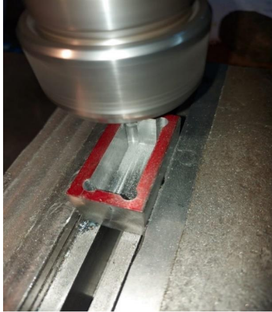
Resim 5.22. Smart marka fireze cihazı ile çelik prizma tesfiyesi
