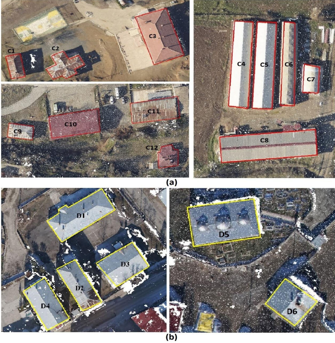
Şekil 61. Düzgünleştirilmiş ortogonal bina sınırları: a) Elâzığ ve b) Erzurum
