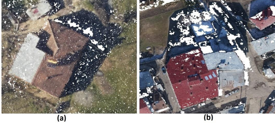
Şekil 66. Fotogrametrik nokta bulutunda gölgelik alanlardan kaynaklı nokta eksiklikleri: a) Elâzığ ve b) Erzurum çalışma alanı
