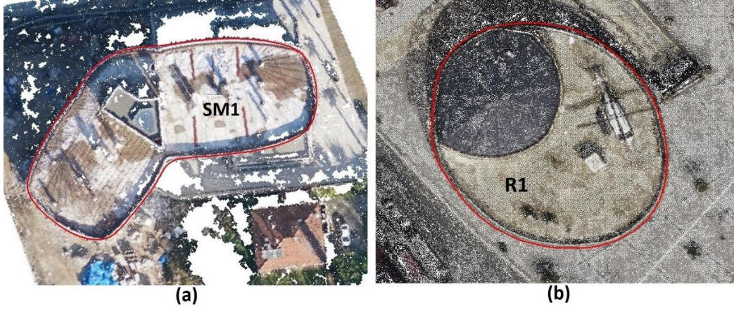
Şekil 63. Düzgünleştirilmiş eğrisel bina sınırları: a) Samsun ve b) Rize
