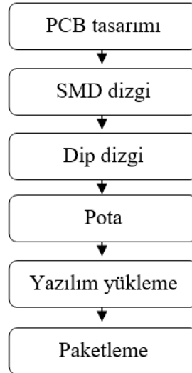
Şekil 4.1. Akülü araba baskı devre kartı üretim aşamaları
