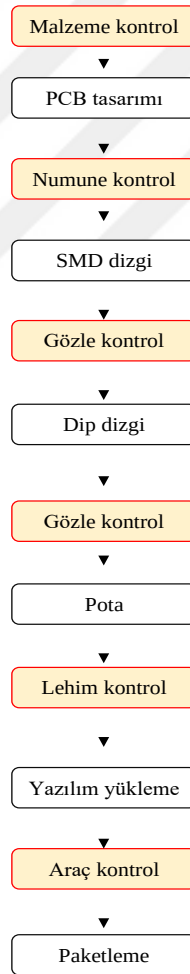
Şekil 4.2. Elektronik devre kartı üretim sürecinin kontrol noktaları
