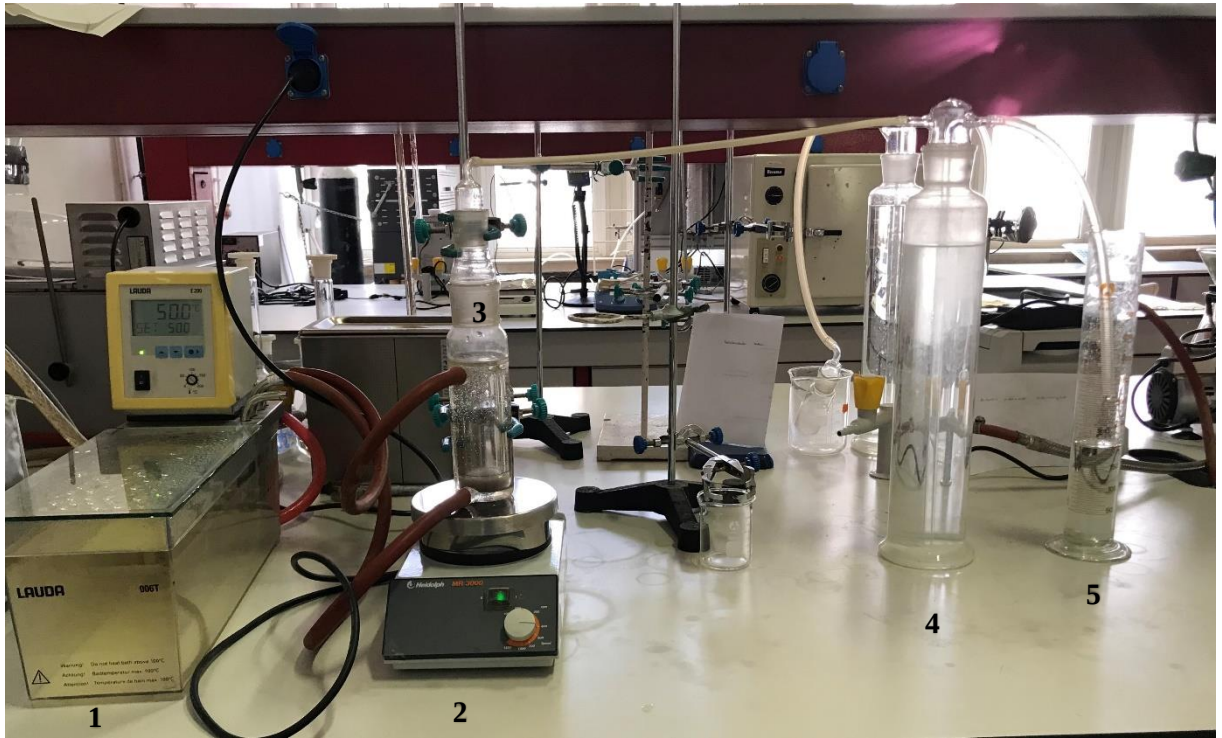
Şekil 5.1. Deney düzeneđi (1) Sirkülatörlü su banyosu, (2) Manyetik karıştırıcı, (3) Ceketli cam reaktör, (4) Gaz toplama şişesi, (5) Su toplama kabı
