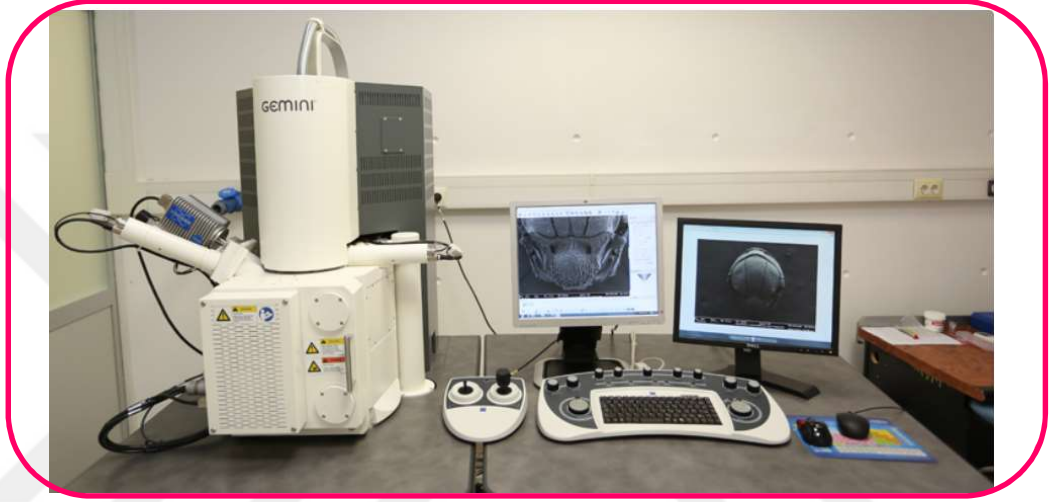
Şekil 7.40 FESEM cihazı görüntüsü
