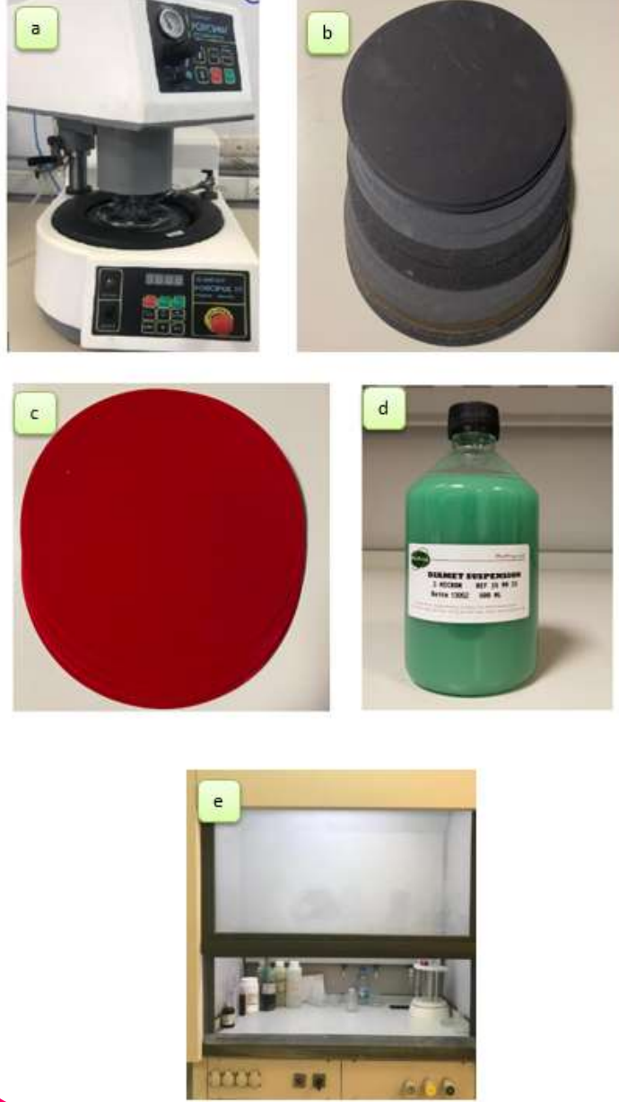
Şekil 7.39: Metalografik İşlemler, a) Otomatik zımparalama ve parlatma cihazı ,b) Zımpara kağıtları, c) Parlatma çuhası,d) Parlatma solüsyonu, e) Dağlama işleminin yapıldığı çeker ocak
