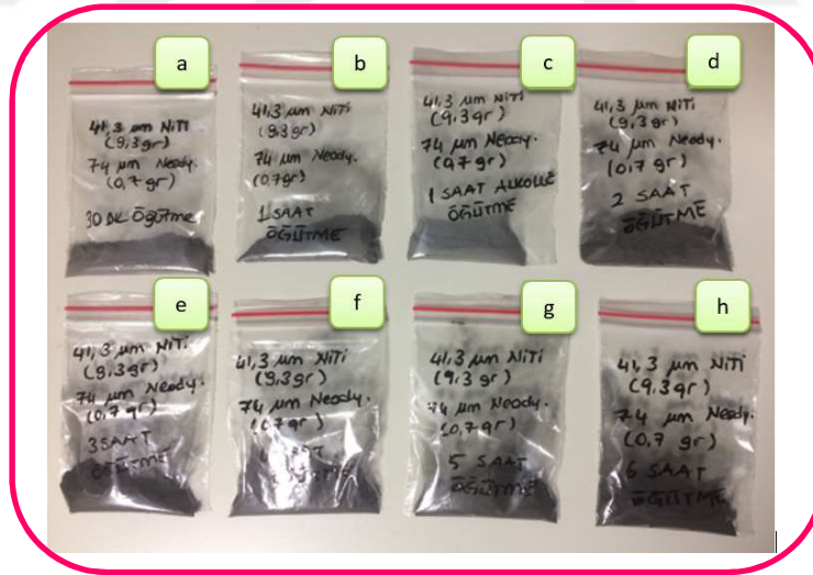
Şekil 7.7: Mekanik alaşımlanan NiTi+Nd Tozları, a) 30dk öğütme, b) 60dk öğütme, c) 60dk alkollü öğütme, d)120dk öğütme, e) 180dk öğütme, f) 240dk öğütme, g) 300dk öğütme, h) 360dk öğütme
