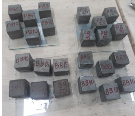
Şekil 3.4. Mekanik deneyler için üretilen numune örnekleri.
