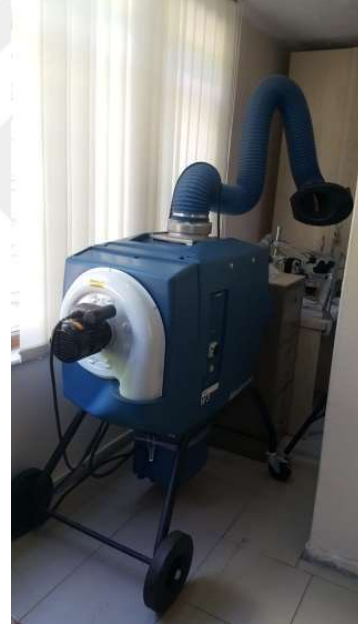
Şekil 31: Portatif, filtreli aspirasyon sistemi
