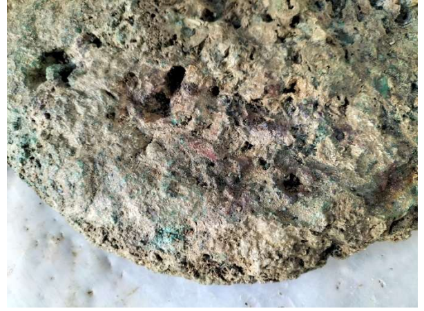
Şekil 38: Çukur Korozyon Oluşumu
