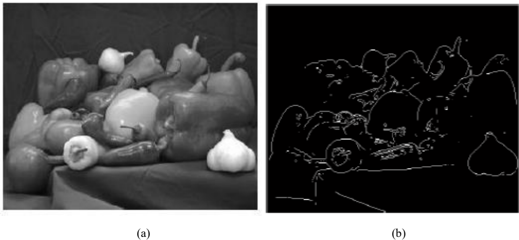
Şekil 3.24. (a) Orijinal görüntü (b) Sobel filtre uygulanmış görüntü [83].
