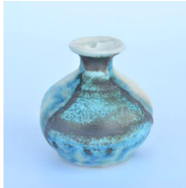
Görsel 48. Porselen Bünye üzerine 1d Nolu Astar Denemesi
