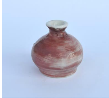
Görsel 94. Porselen Bünye üzerine 5j Nolu Astar Denemesi
