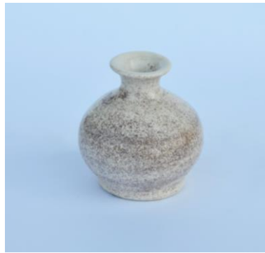
Görsel 80. Porselen Bünye üzerine 4f Nolu Astar Denemesi
