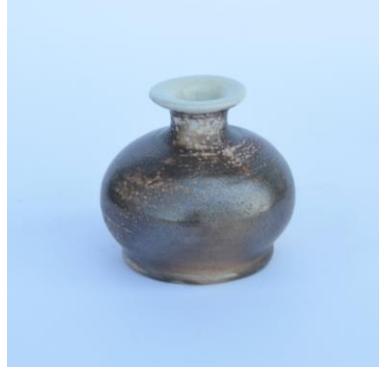
Görsel 65. Porselen Bünye üzerine 3a Nolu Astar Denemesi
