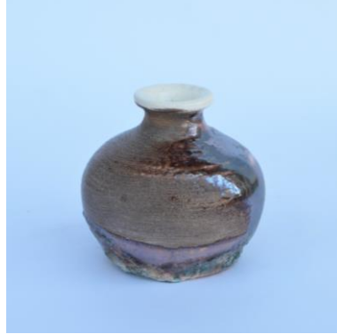
Görsel 55. Porselen Bünye üzerine 2a Nolu Astar Denemesi
