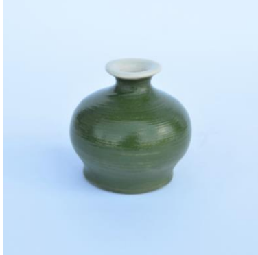
Görsel 57. Porselen Bünye üzerine 2c Nolu Astar Denemesi
