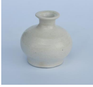
Görsel 39. Soda Pişirimi Yapılmış Porselen Bünye
