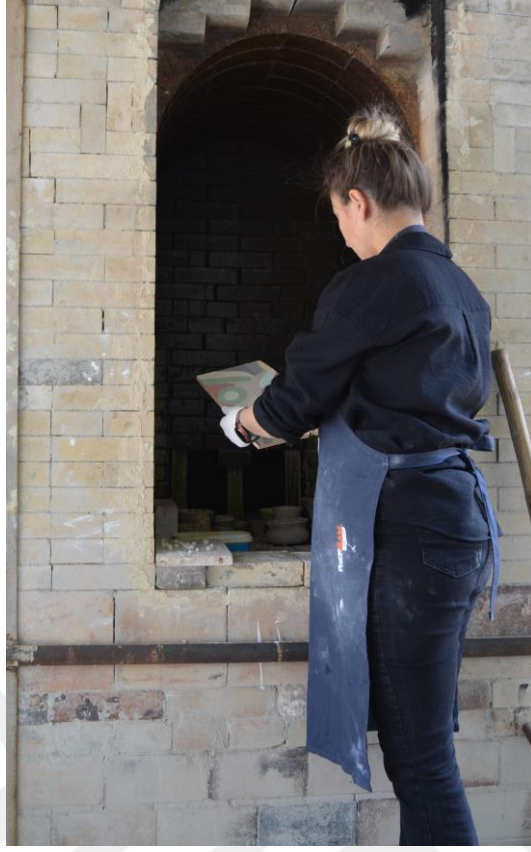
Görsel 8. Seramiklerin Fırına Dizilmesi
