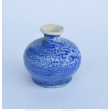
Görsel 83. Porselen Bünye üzerine 4i Nolu Astar Denemesi
