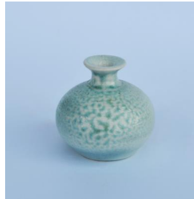
Görsel 62. Porselen Bünye üzerine 2h Nolu Astar Denemesi
