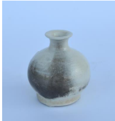
Görsel 76. Porselen Bünye üzerine 4b Nolu Astar Denemesi
