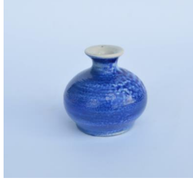
Görsel 63. Porselen Bünye üzerine 2i Nolu Astar Denemesi
