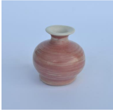
Görsel 54. Porselen Bünye üzerine 1j Nolu Astar Denemesi
