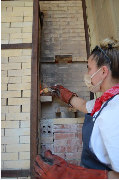
Görsel 15. Soda'nın Paketler Yardımı İle Fırına Verilmesi
