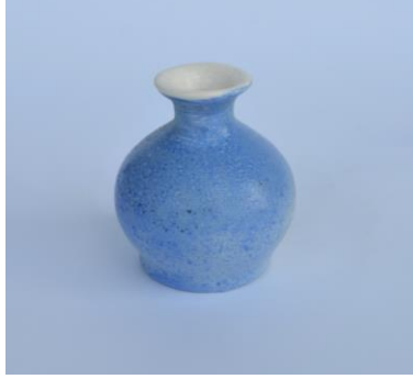
Görsel 53. Porselen Bünye üzerine 1i Nolu Astar Denemesi
