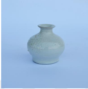
Görsel 40. Porselen Bünye üzerine 1 Nolu Astar Denemesi
