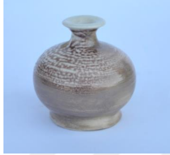
Görsel 45. Porselen Bünye üzerine 1a Nolu Astar Denemesi
