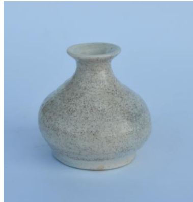
Görsel 50. Porselen Bünye üzerine 1f Nolu Astar Denemesi
