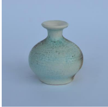
Görsel 71. Porselen Bünye üzerine 3g Nolu Astar Denemesi
