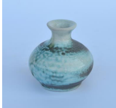
Görsel 78. Porselen Bünye üzerine 4d Nolu Astar Denemesi
