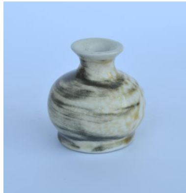
Görsel 56. Porselen Bünye üzerine 2b Nolu Astar Denemesi
