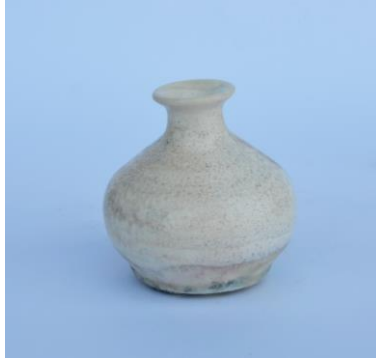
Görsel 41. Porselen Bünye üzerine 2 Nolu Astar Denemesi
