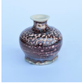
Görsel 85. Porselen Bünye üzerine 5a Nolu Astar Denemesi
