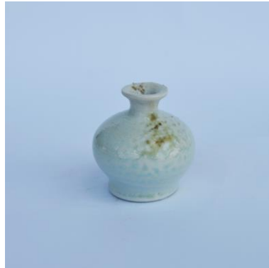
Görsel 92. Porselen Bünye üzerine 5h Nolu Astar Denemesi
