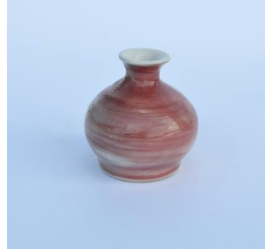
Görsel 64. Porselen Bünye üzerine 2j Nolu Astar Denemesi
