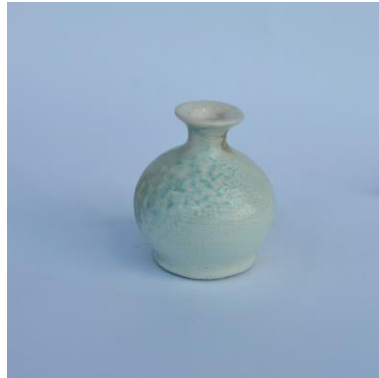
Görsel 82. Porselen Bünye üzerine 4h Nolu Astar Denemesi
