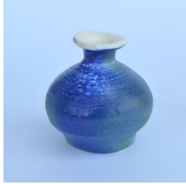
Görsel 49. Porselen Bünye üzerine 1e Nolu Astar Denemesi
