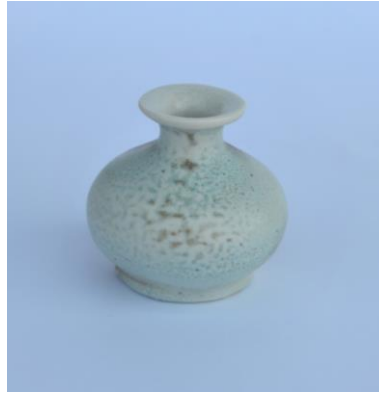
Görsel 68. Porselen Bünye üzerine 3d Nolu Astar Denemesi
