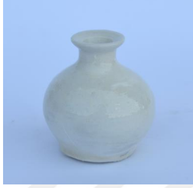
Görsel 44. Porselen Bünye üzerine 5 Nolu Astar Denemesi
