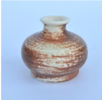
Görsel 46. Porselen Bünye üzerine 1b Nolu Astar Denemesi
