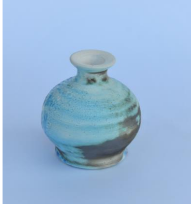
Görsel 58. Porselen Bünye üzerine 2d Nolu Astar Denemesi
