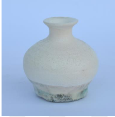
Görsel 42. Porselen Bünye üzerine 3 Nolu Astar Denemesi
