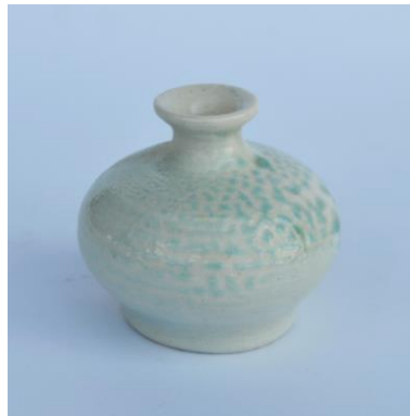
Görsel 52. Porselen Bünye üzerine 1h Nolu Astar Denemesi
