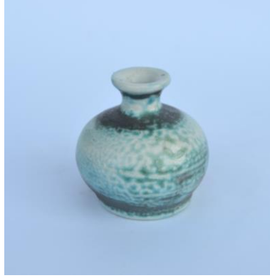
Görsel 61. Porselen Bünye üzerine 2g Nolu Astar Denemesi
