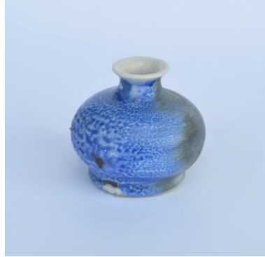
Görsel 73. Porselen Bünye üzerine 3i Nolu Astar Denemesi
