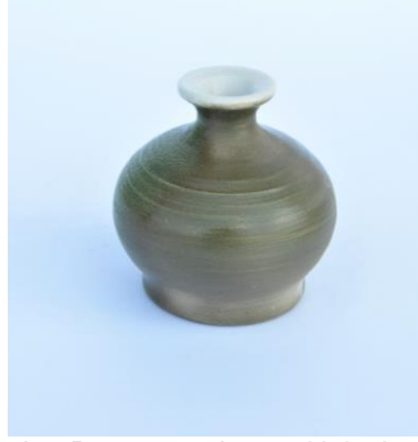
Görsel 67. Porselen Bünye üzerine 3c Nolu Astar Denemesi
