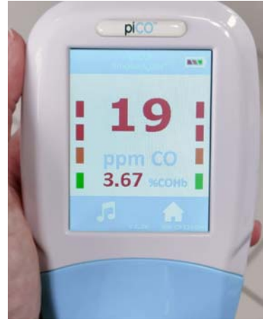
Şekil 3.7.1.1: SDG operasyonu öncesi smokerlyzer cihazı kullanılarak sigara tüketmeyen (sol) ve sigara tüketen (sağ) bireylerden yapılan COOppm ölçümü değerleri
