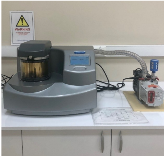
Resim 18. SEM görüntülemesi için altın palladyum kaplama cihazında kaplanan örnekler
