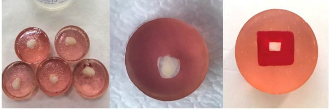
Resim 2. Mikrosertlik ölçümü yapılacak örneklerin kalıplardan çıkarıldıktan sonra, zımparalama işleminden sonra, ve aside dayanıklı tırnak cilası ile 5x3 mm'lik pencere oluşturulmasından sonraki görüntüleri
