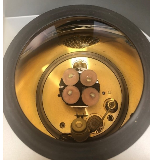
Resim 18. SEM görüntülemesi için altın palladyum kaplama cihazında kaplanan örnekler
