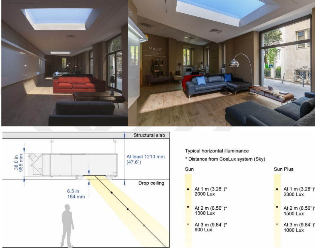
Şekil 3.2.10. Coelux 45 HC, tavan yerleşim detayı / Spazio Inovazione Of Ars Et Inventio, İç mekân detayı. Farklı yüksekliklere göre birim alana düşen ışık şiddeti.
