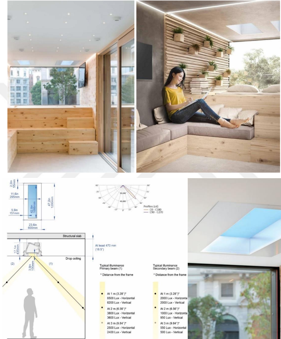
Şekil 3.2.19. Coelux ICE, yapay gün ışığı penceresi iç mekân uygulama görseli ve Farklı yüksekliklere göre birim alana düşen ışık şiddeti, tavan yerleşim detayı.
