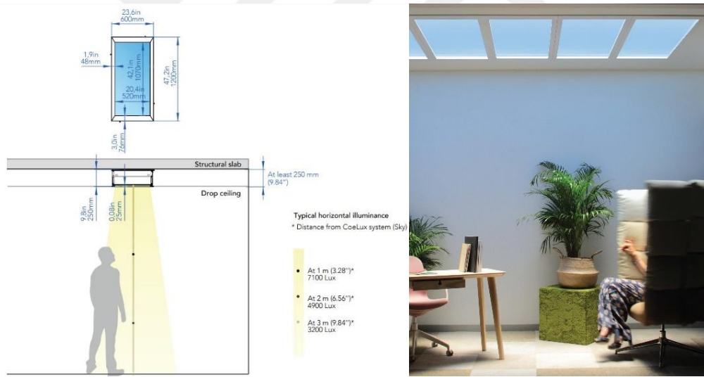
Şekil 4.16. High Tech 25 Klasik, plan ve kesit görseli. Farklı yüksekliklere göre değişen ışık lux değerleri.
