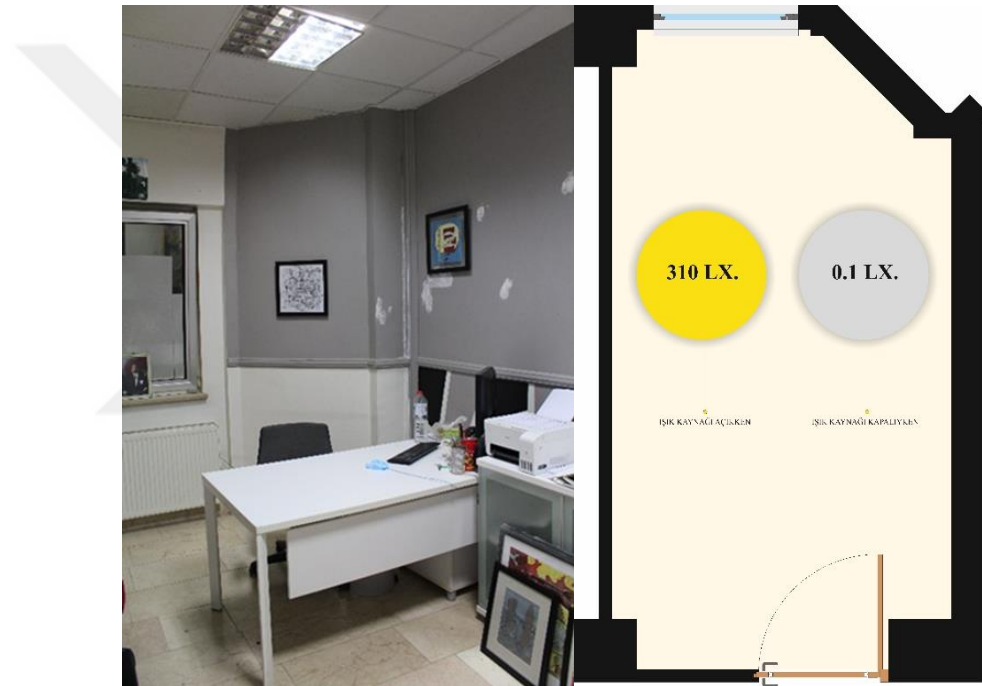
Şekil 4.8. Işık kaynağı kapalıyken ve açıkken yapılan aydınlık düzeyi ölçümleri, plan üzerinden gösterimi. Işık kaynağı açıkken iç mekândan çekilen fotoğraf.
