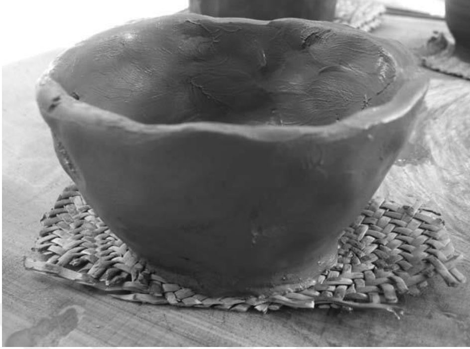
Resim 2.33. Seramiğin Hasır Üzerinde Şekillendirilmesi İşlemi
