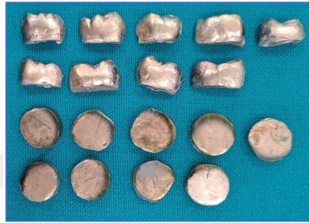
Şekil 3.14. Altınla kaplanmış mine ve kompozit rezin örnekleri
