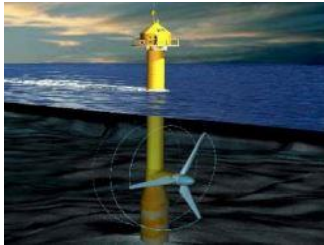
Şekil 9. Deniz akıntısı türbini (Ataman, 2007)
