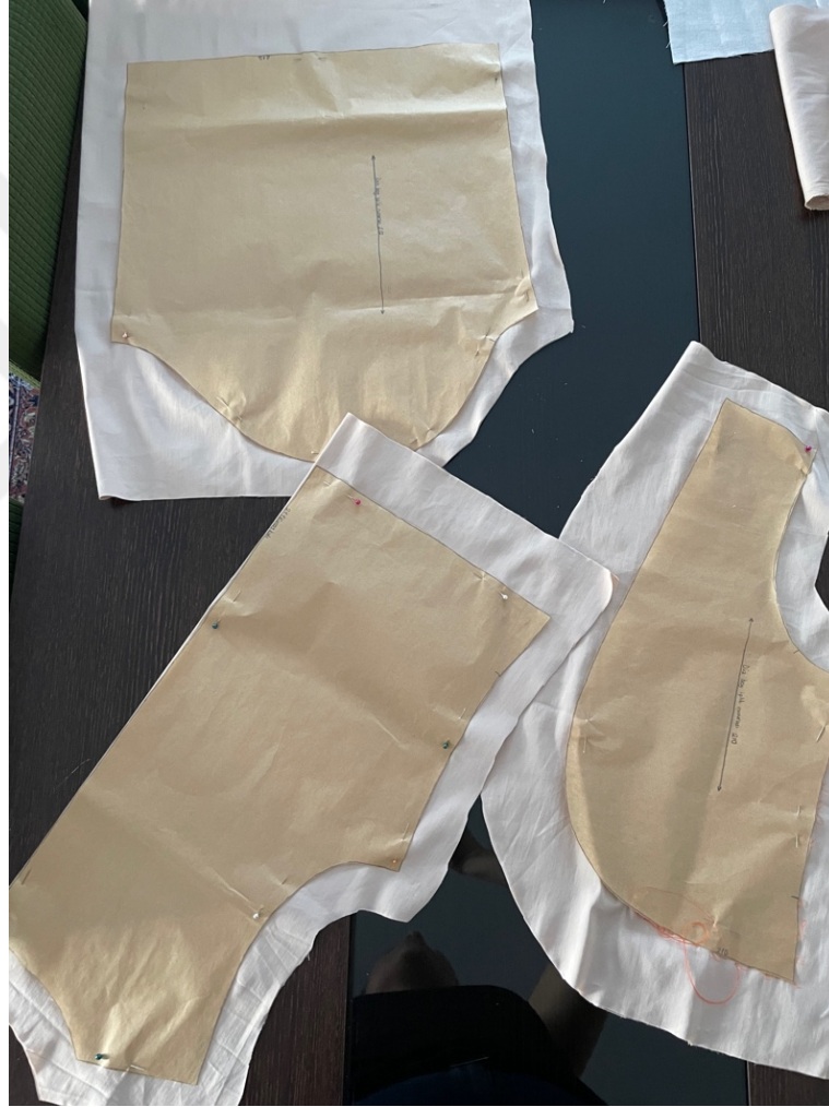
řekil 105. "Meltem" isimli tasarımın ceket kalıbının kumařa aktarılması (Serdar, 2023)
