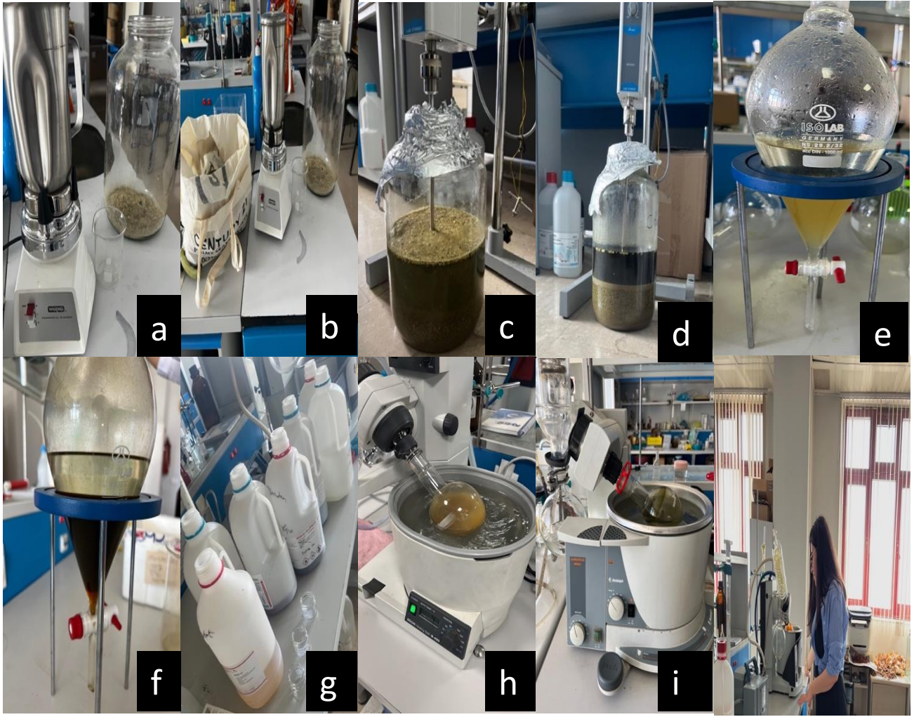
Şekil 3.1. Ekstraksiyon işlemlerinde kullanılan solvan ve cihazlar. a.b.: toz etme işlemi, c.d.: ekstraksiyon, e.f.: sıvı-sıvı ekstraksiyon, g.: fraksiyonlanan ekstreler, h.i.: fraksiyonlama işlemi.
