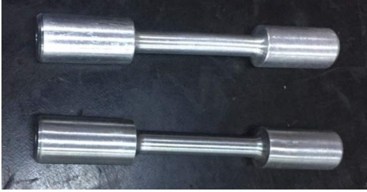
Resim 5.16. Üçüncü ray çekme deney numuneleri
