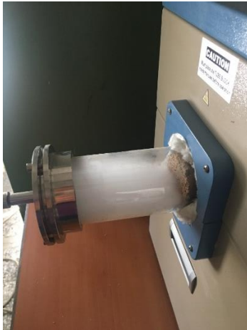
Resim 5.19. Sinterleme sırasındaki su buharı oluşumu
