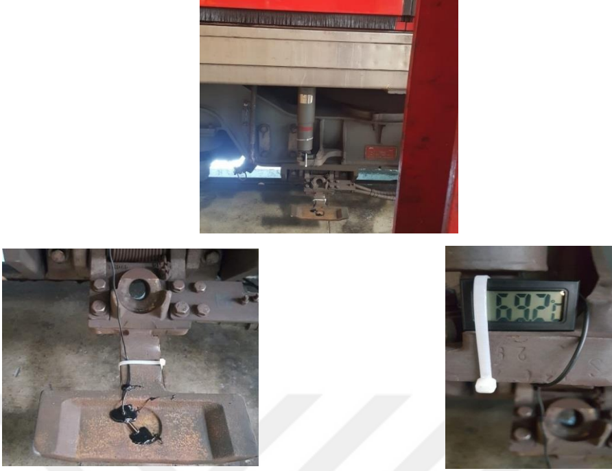
Resim 5.24. Kollektör pabucu üzerinden gerçek sıcaklık ölçümü
