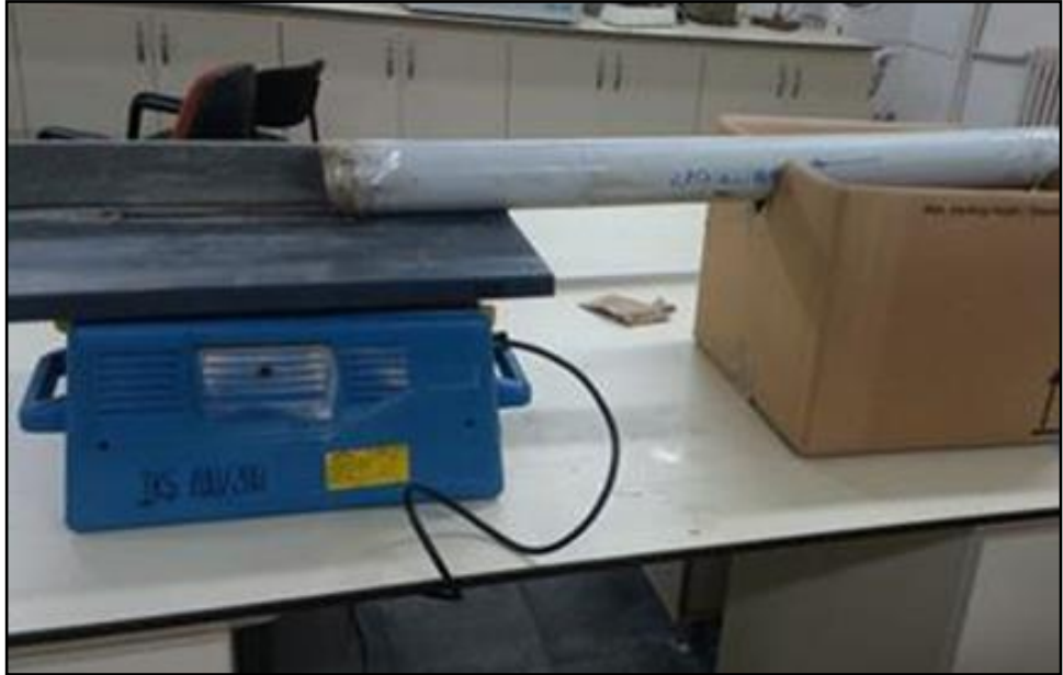
Şekil 11. Karot numunesini boyuna iki eş parçaya ayıran kesici alet.
