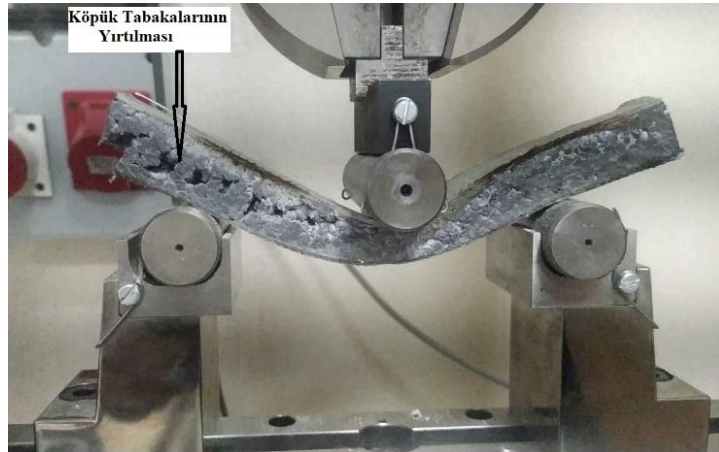
Resim 4.13 EPS köpük çekirdekli numunesinin basma test sonu görünüşü.
