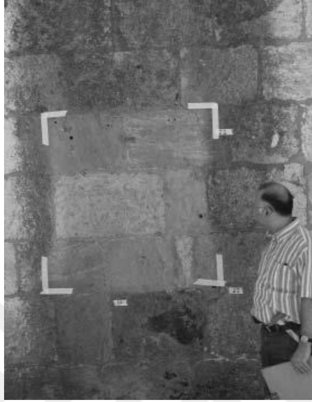
Fotoğraf 192: Sokullu Mehmet Paşa Kervansarayının Mikro Kumlama ile Temizlik Denemeleri Sonucu (Eskici, 2008: 89)
