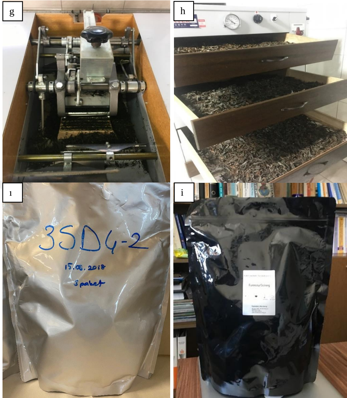
Şekil 3.2. Çayların üretim aşamaları ve muhafazası; a) soldurma; b) enzim inaktivasyonu; c) fermentasyon; d) ortodoks kıvrırma; e) 1. döner tamburlu kıvrırma; f) 2. döner tamburlu kıvrırma; g) son kıvrırmalı kurutma; h) son kurutma; ı) paketleme; i) Formosa oolong (kontrol örneği)
