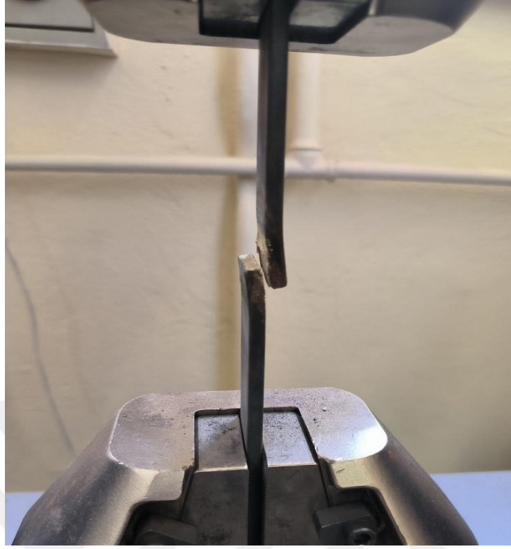
Şekil 3.10. 5 mm kalınlığındaki St37 çeliğine ait bindirmeli kesme test sonucu kesme anı
