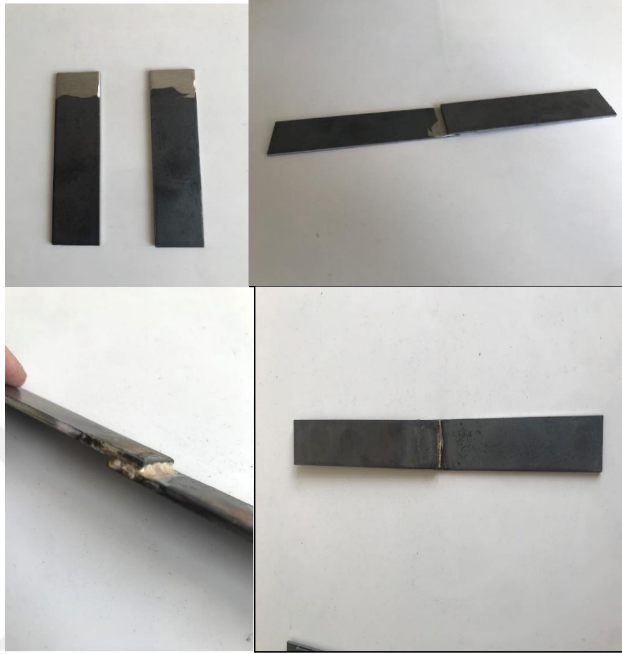
Şekil 3.7. St37 çeliğinin lehimlenmesi ile elde edilen numune örnekleri
