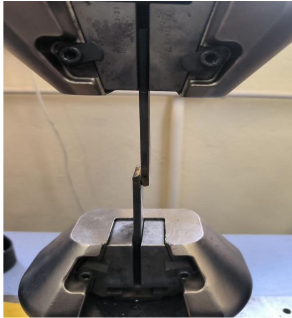
Şekil 3.9. 5 mm kalınlığındaki St37 çeliği bindirmeli kesme testine tabi tutulurken
