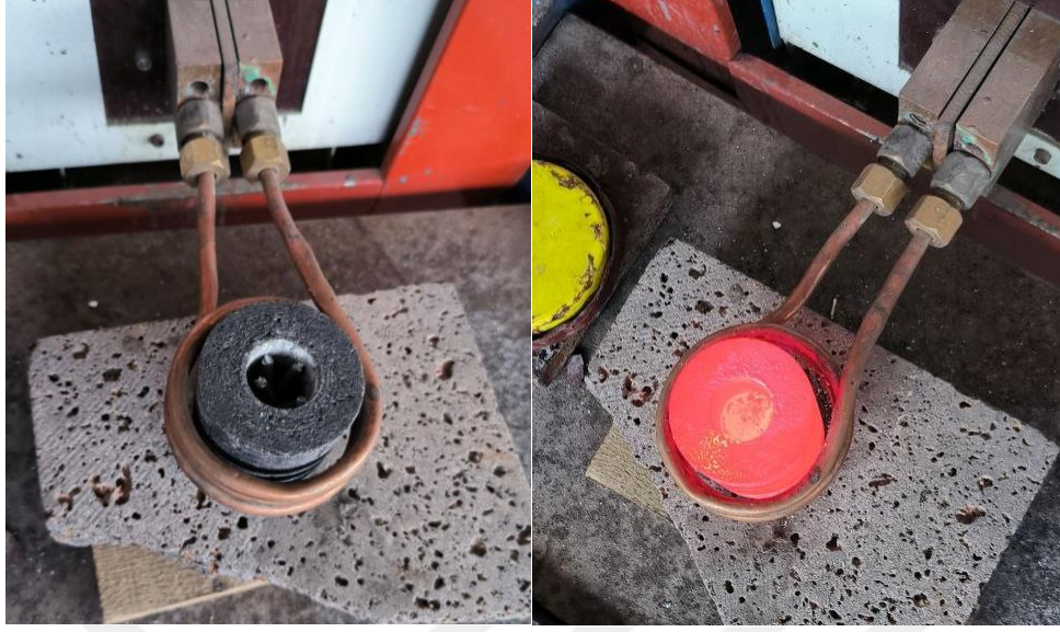
Şekil 3.3. İndüksiyonla eritme ve alaşımlama işlemi
